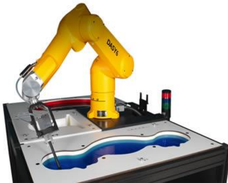
Slika 4. Testiranje zračenja na fantomskoj glavi, [30]
