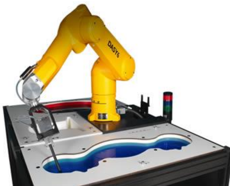
Slika 4. Testiranje zračenja na fantomskoj glavi, [30]
