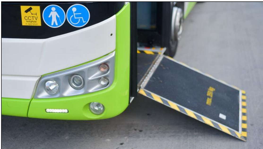
Slika 15. Rampa za autobuse
