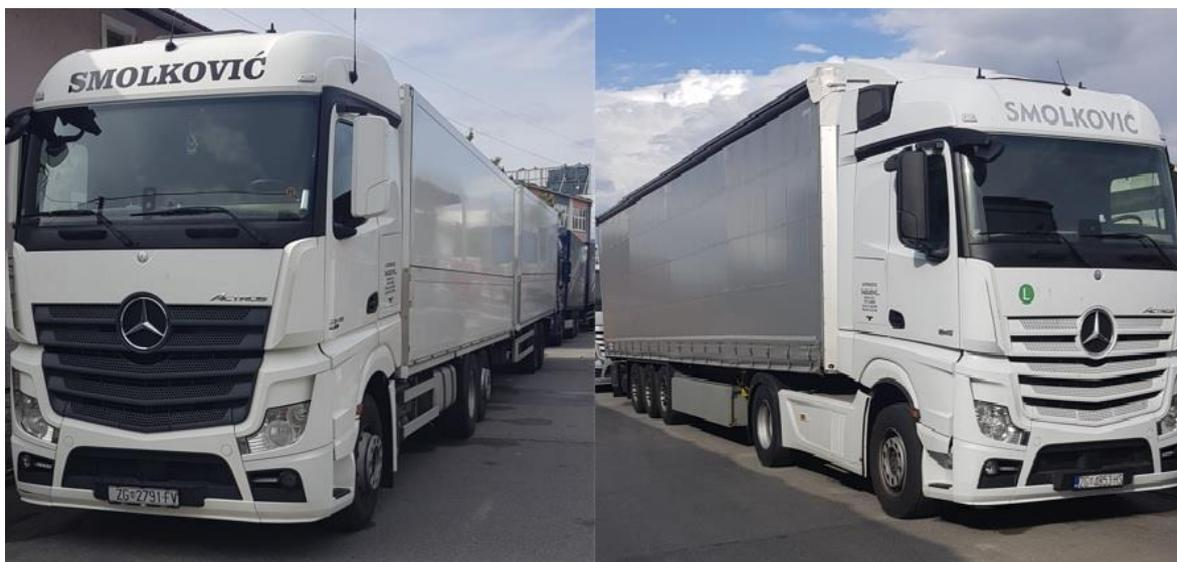
**Slika 6.** Lijevo tegljač s poluprikolicom, a desno tegljač s prikolicom.
