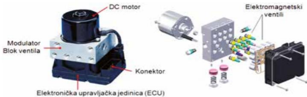
Slika 11. Komponente hidrauličko-elektroničke upravljačke jedinice [5]
