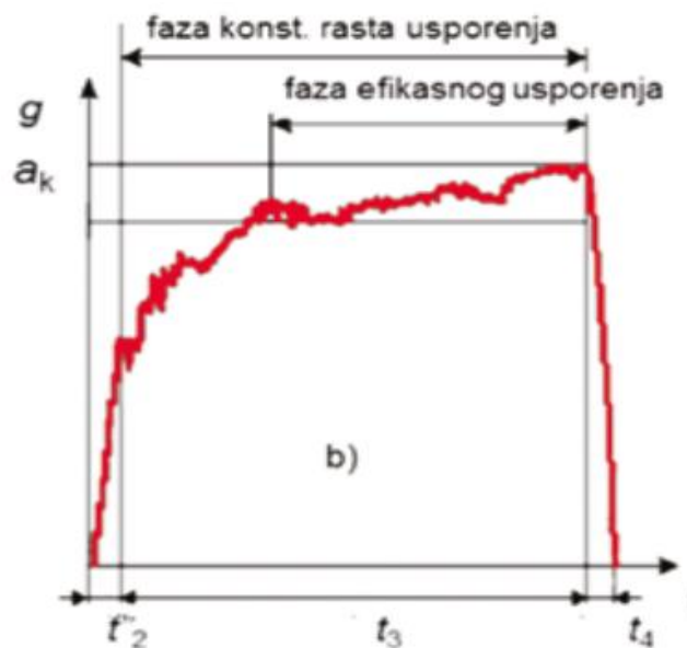
Slika 17. Dijagram kočenja vozila sa ABS-om [5]
