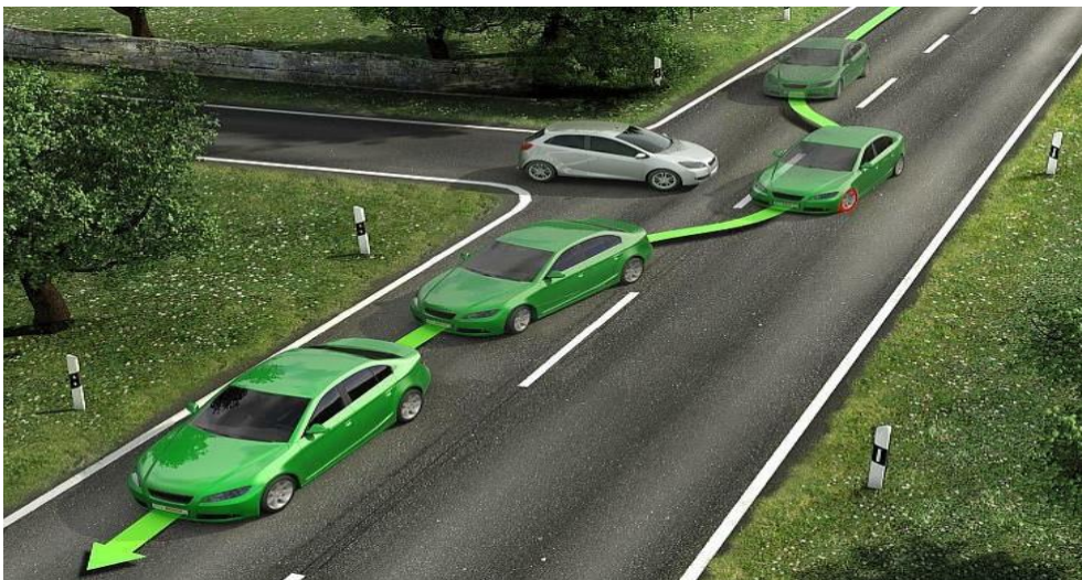
Slika 8. Prikaz djelovanja ESP-a pri obilaženju opasnosti [11]
