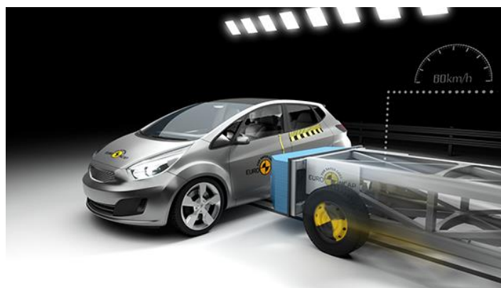
Slika 9. Prikaz bočnog sudara s pokretnom deformabilnom barijerom, [10]
