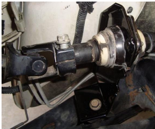
Slika 4. Spoj upravljača i upravljačkog stupa
