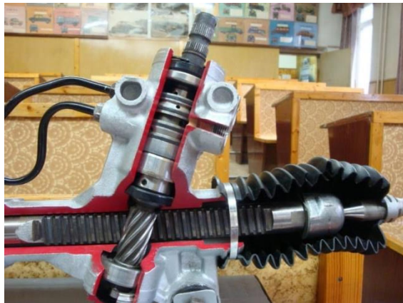
Slika 14. Mehanički prijenosnik sa zupčastom letvom upravljača
