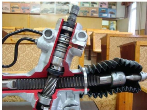
Slika 14. Mehanički prijenosnik sa zupčastom letvom upravljača
