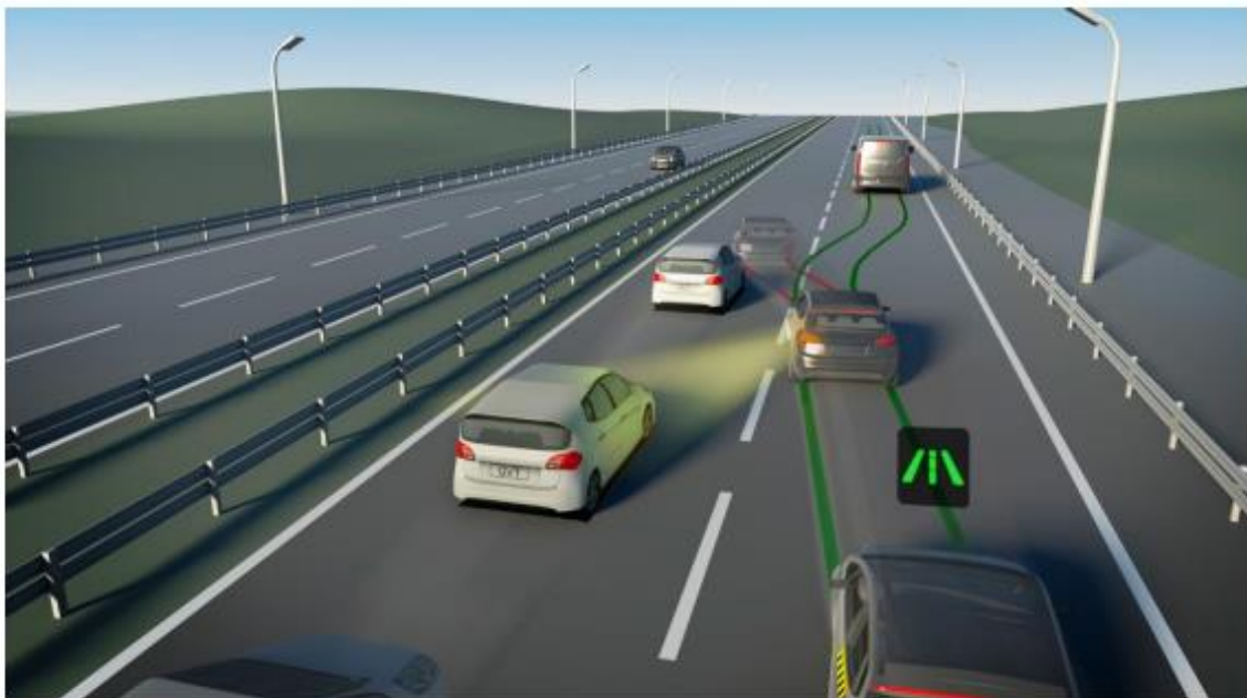
Slika 6. Prikaz aktiviranja ELK sustava prilikom pretjecanja koristeći sustav praćenje mrtvog kuta (BSM), [9]
