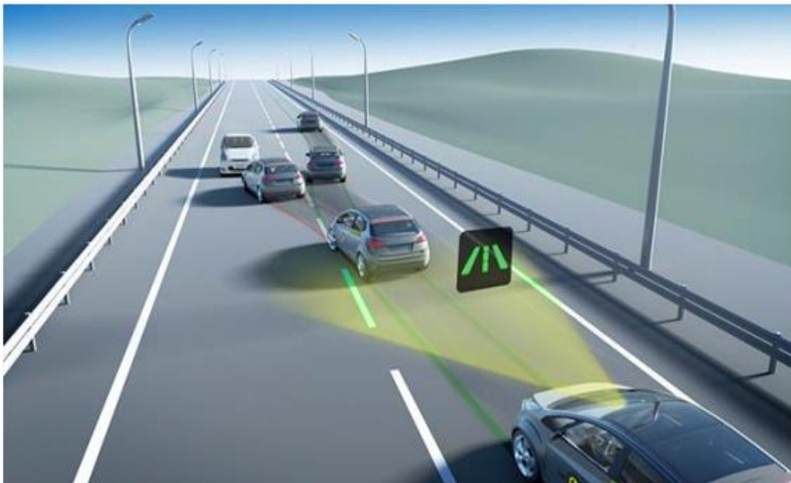
Slika 5. Prikaz aktiviranja ELK sustava na nadolazeći promet i vraćanja vozila u svoju traku, [9]
