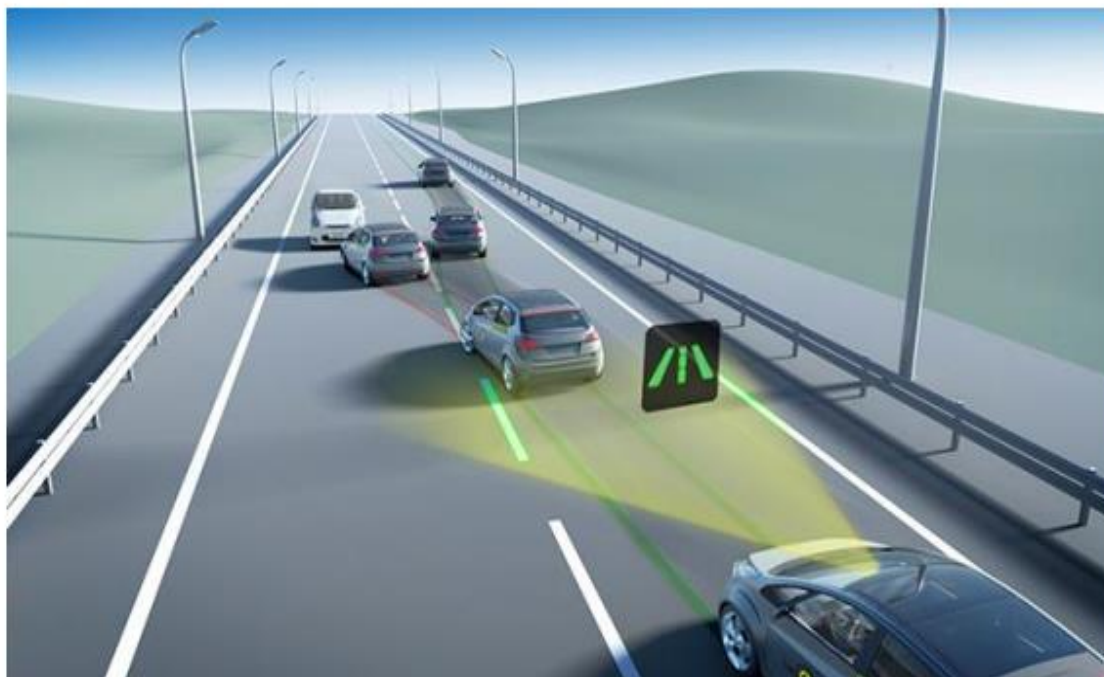
Slika 5. Prikaz aktiviranja ELK sustava na nadolazeći promet i vraćanja vozila u svoju traku,
