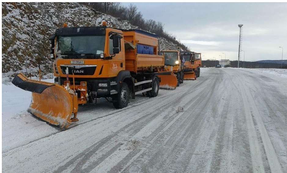
Slika 20: Zimska služba sa ralicama i posipačima
