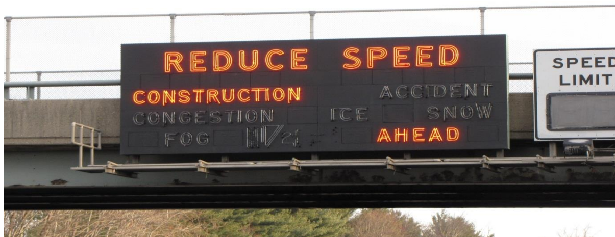
Slika 13. Prikaz svijetlećeg panela u New Jerseyu (Sjedinjene Američke Države) sa putnom informacijom o smanjenju brzine zbog radova na cesti.
