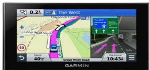
Slika 3. Prikaz TTI sustava koji pravovremeno obavještava korisnika o udaljenosti do odredišta, dolasku na odredište te trenutnu brzinu.
