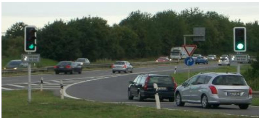
Slika 5. Prikaz ramp metering sustava implementiranog u Njemačkoj.
