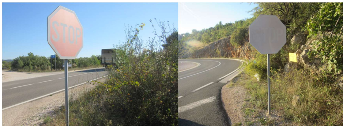
Slika 21. Degradacija crvene boje
