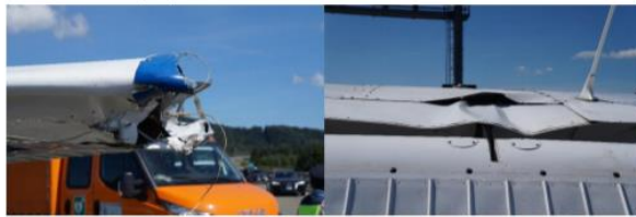
Slika 1 – Oštećenje vrha krila
