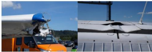
Slika 1 – Oštećenje vrha krila
