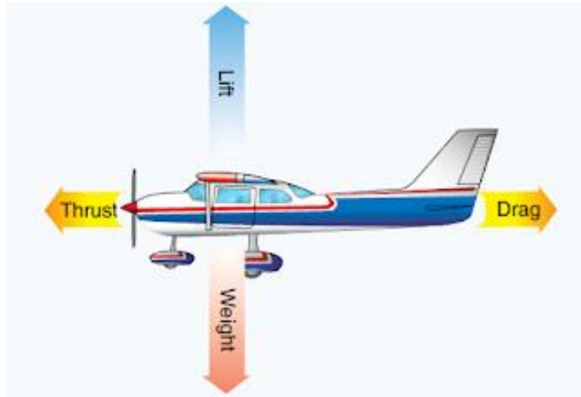
Slika 3: Sile koje djeluju na zrakoplov u horizontalnom letu [4]
