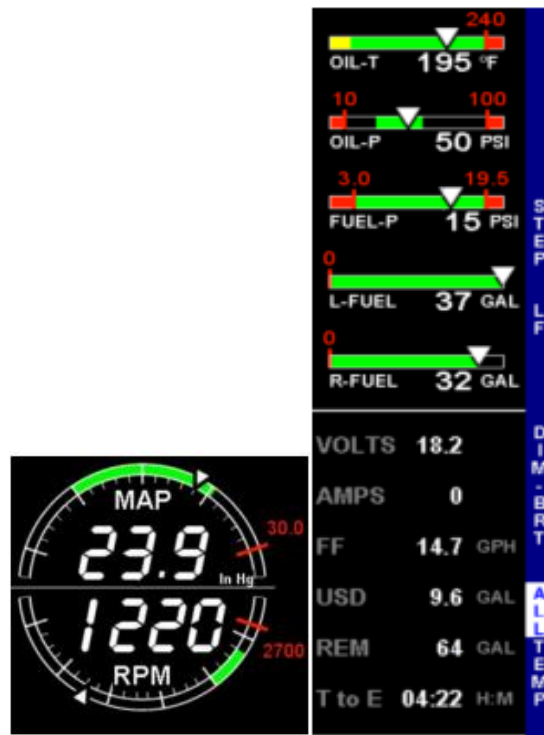
Slika 8. Izgled vertikalnog prikaznika [6]
