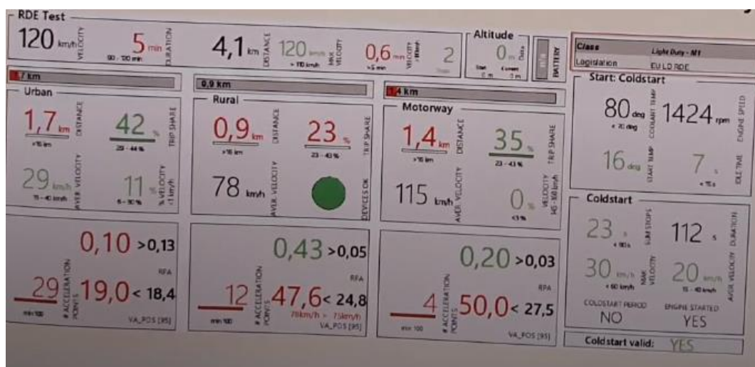
Slika 8 Prikaz rezultata mjerenja pomoću sustava PEMS na cestovnom vozilu
