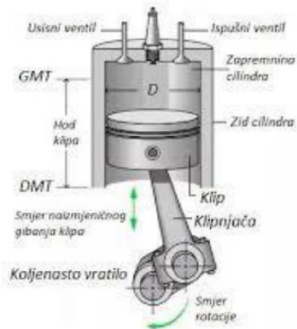
Slika 1 zrakoplovnog klipnog motora s označenim glavnim dijelovima [1]
