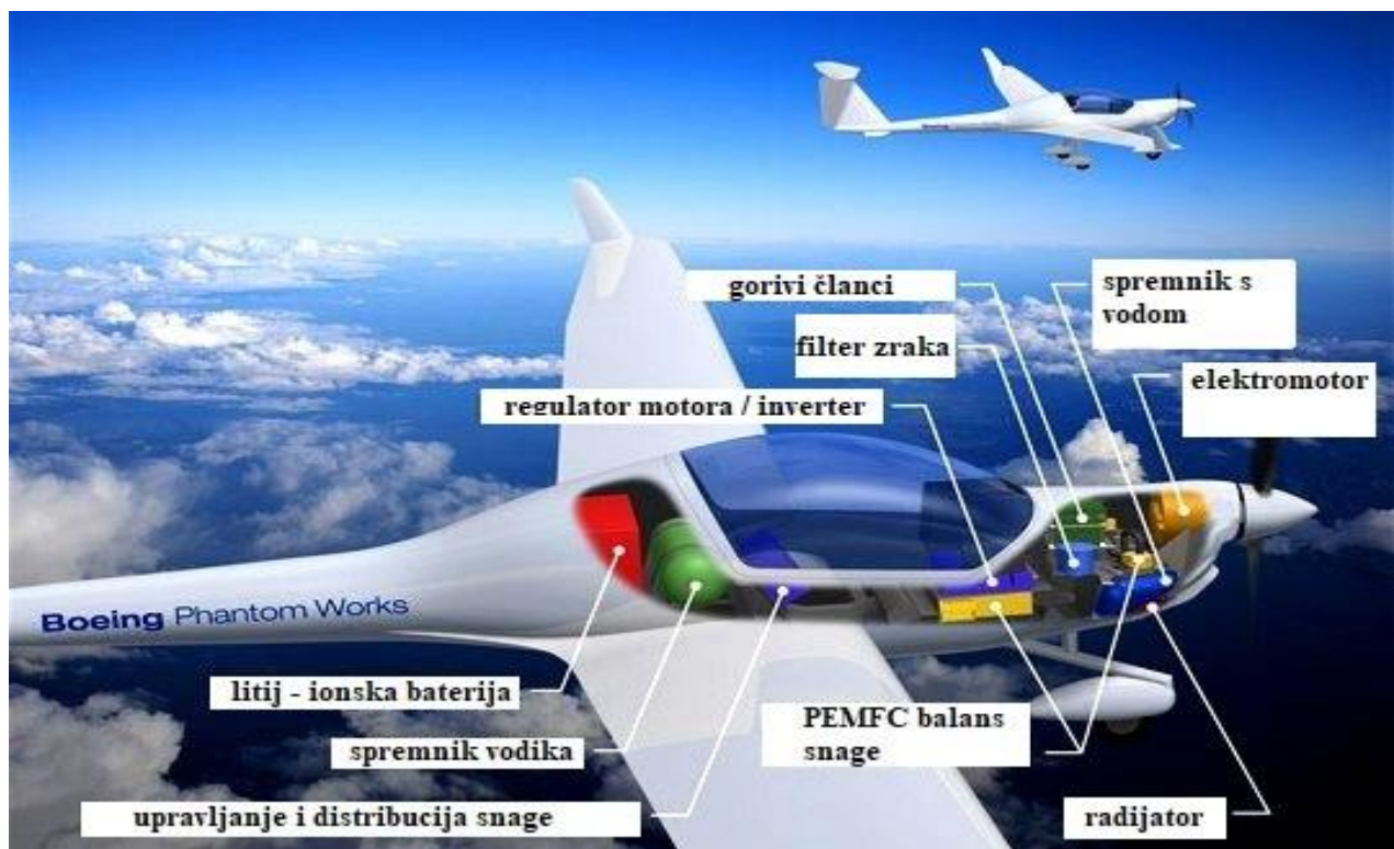
Slika 4 Dijelovi hibridnog pogonskog sustava zrakoplova Diamond HK36 Super Dimona Izvor: [11]
