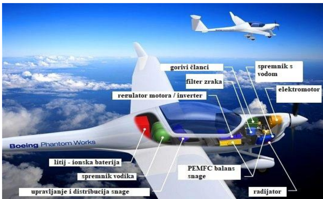
Slika 4 Dijelovi hibridnog pogonskog sustava zrakoplova Diamond HK36 Super Dimona
