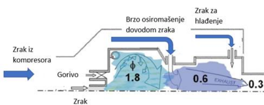
Slika 18. Model RQL komore izgaranja, [1]
