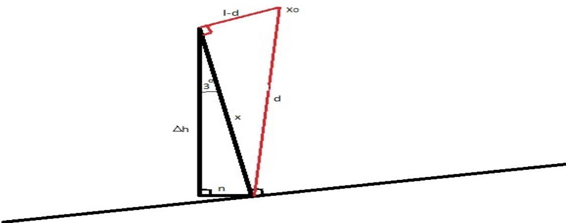
Slika 13 Grafički prikaz vertikalnog i horizontalnih odstupanja
