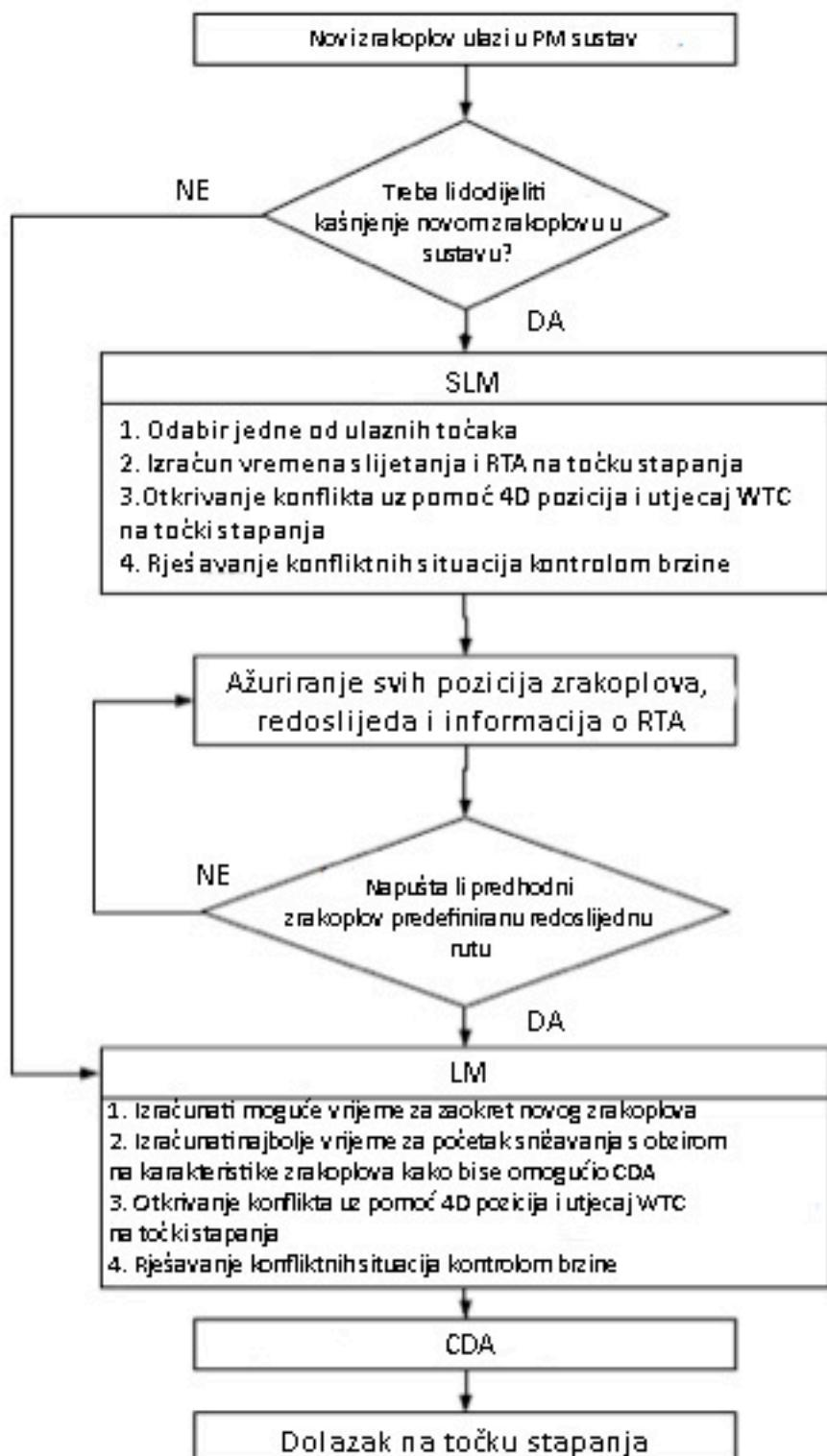
Slika 8 Dijagram toka za modeliranje dolaska zrakoplova u PM sustav [8]
