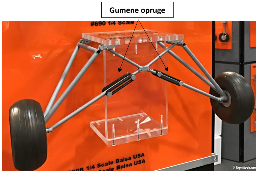
Slika 7. Model podvozja s gumenim oprugama
