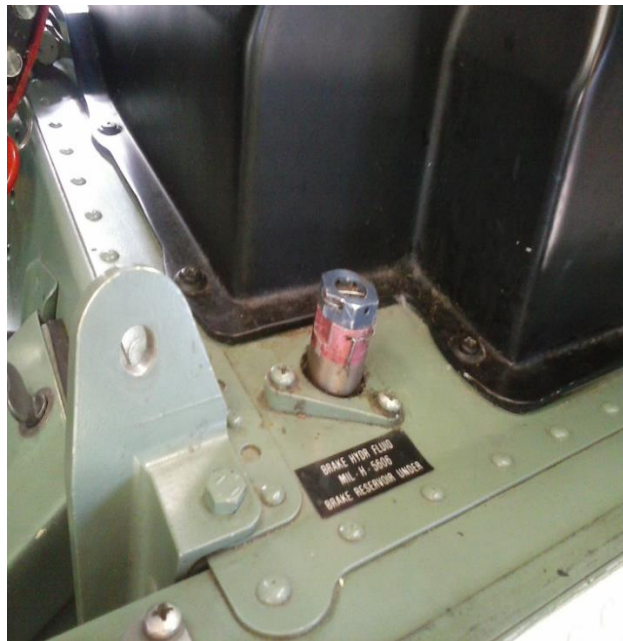
Slika 16. Indikator količine ulja kočionog sustava zrakoplova PC-9M
