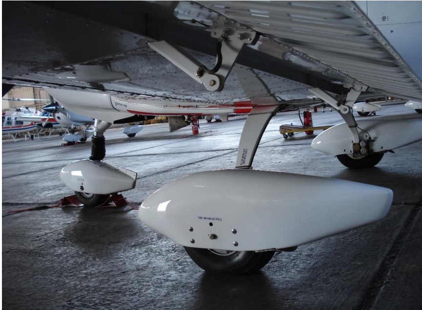
Slika 6. Čelične opružne noge na zrakoplovu Zlin 242L
