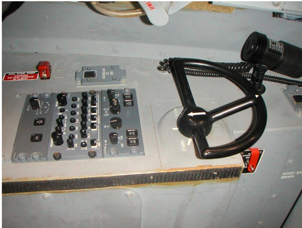
Slika 4. Upravljač nosne noge zrakoplova CL-415
