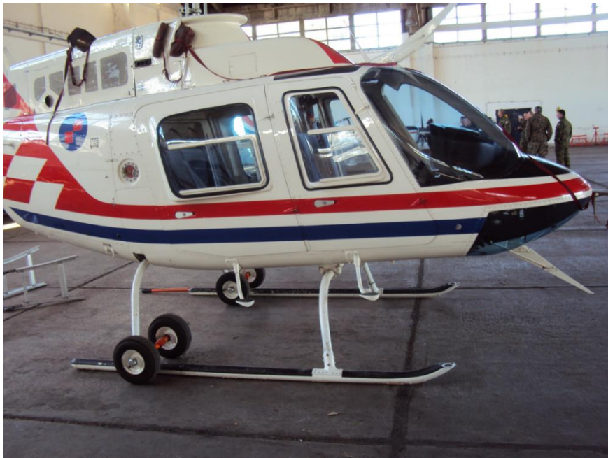
Slika 5. Podvozje tipa "skije" helikoptera Bell 206B
