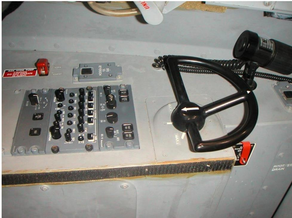
**Slika 4. Upravljač nosne noge zrakoplova CL-415**
