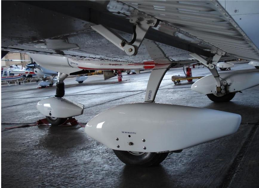
**Slika 6. Čelične opružne noge na zrakoplovu Zlin 242L**
