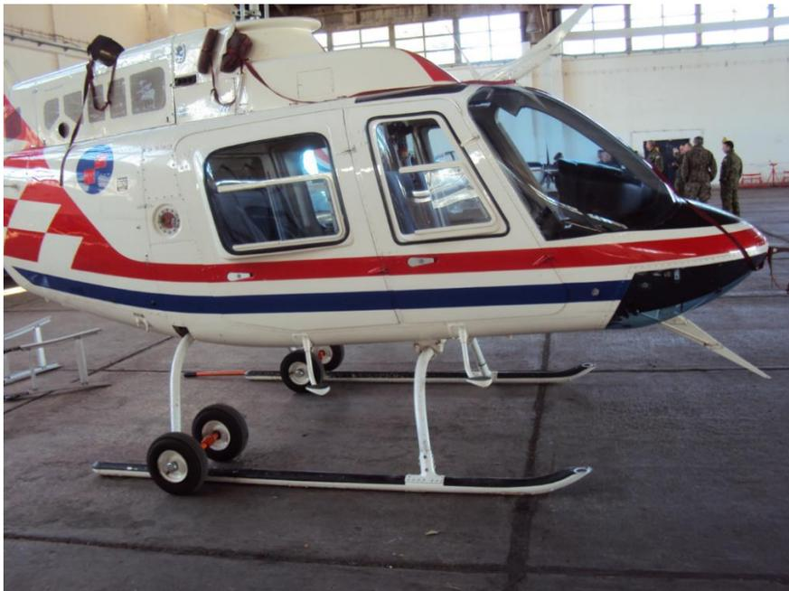
**Slika 5. Podvozje tipa "skije" helikoptera Bell 206B**
