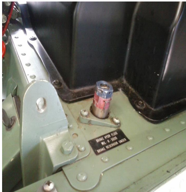
Slika 16. Indikator količine ulja kočionog sustava zrakoplova PC-9M
