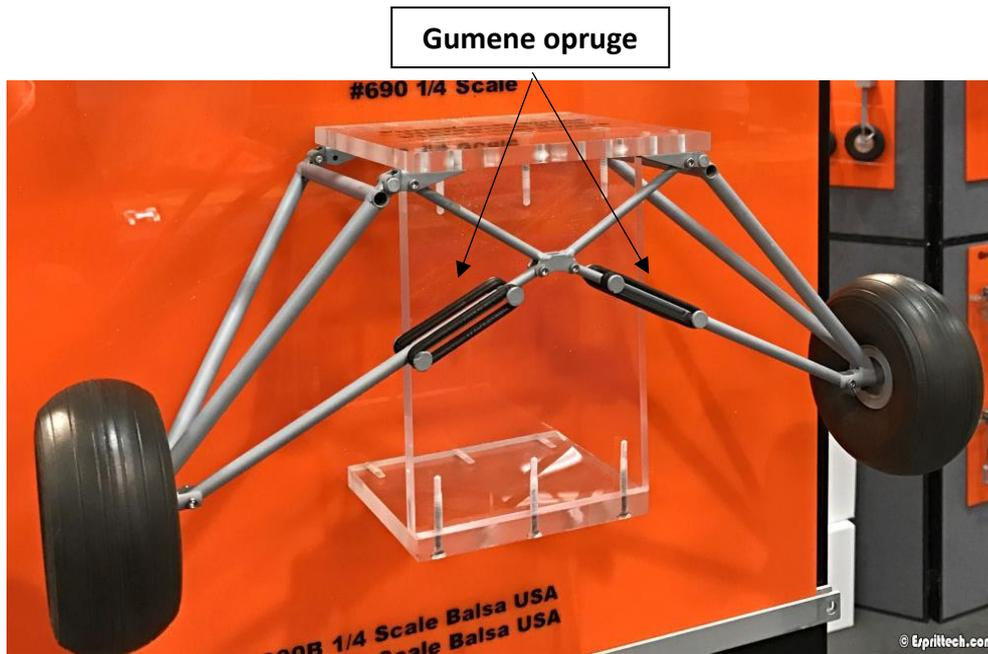
**Slika 7. Model podvozja s gumenim oprugama**
