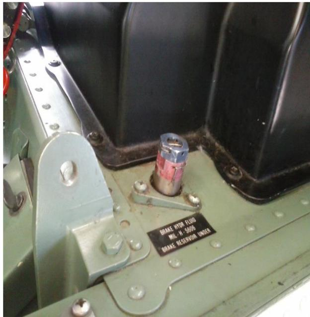
**Slika 16. Indikator količine ulja kočionog sustava zrakoplova PC-9M**
