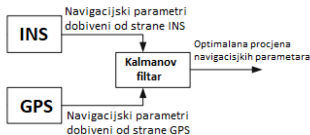
Slika 5. Blok-shema primjene izravnog Kalmanovg filtra u fuziji INS/GPS
