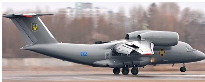
Slika 24. Mlaznička zakrilca na avionu Antunov An-72
