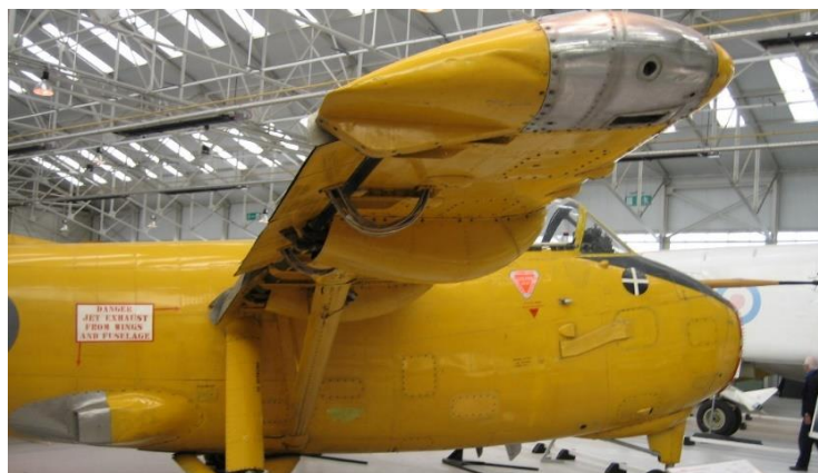
Slika 23. Mlaznička zakrilca na avionu Hunting H.126
