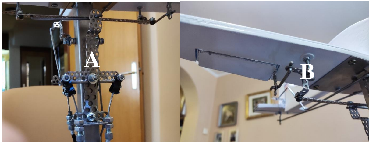
Slika 10.6. b) Prijenosni mehanizam pomaka palice lijevo-desno na centralnom stupu i na krilu zrakoplova
