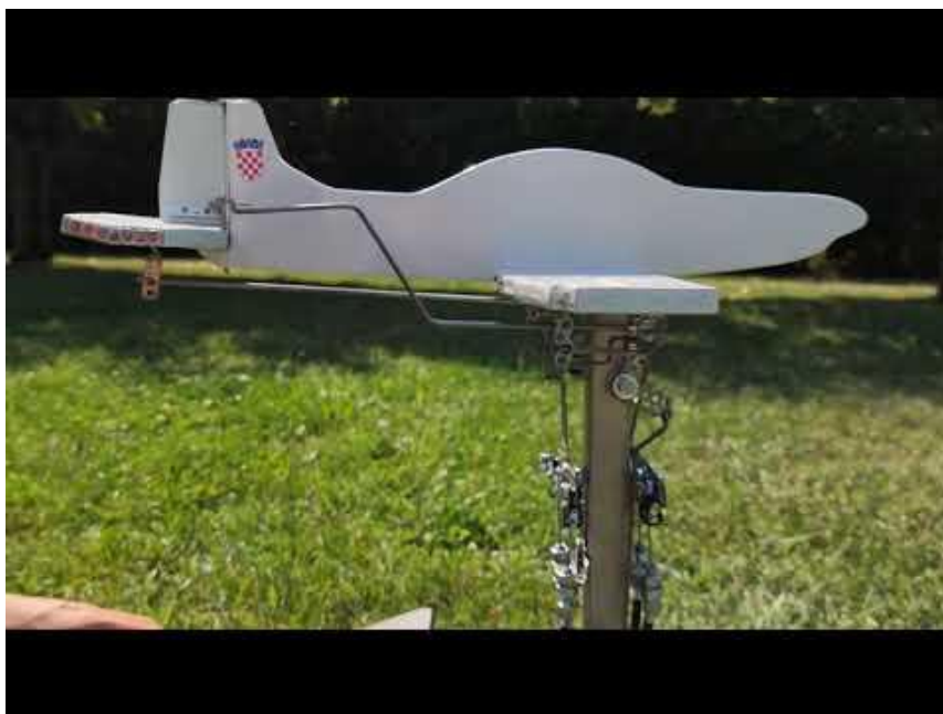
Video 10.1 Demonstracija funkcionalnog modela upravljačkih površina
