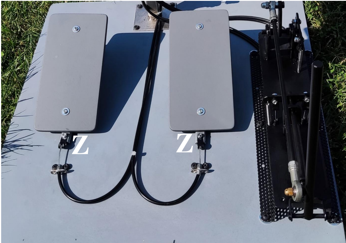
Slika 10.5. Nožne komande i mehanizam palice na postolju
