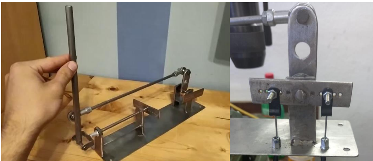
Slika 10.1. a) Mehanizam palice i način spajanja sajli
