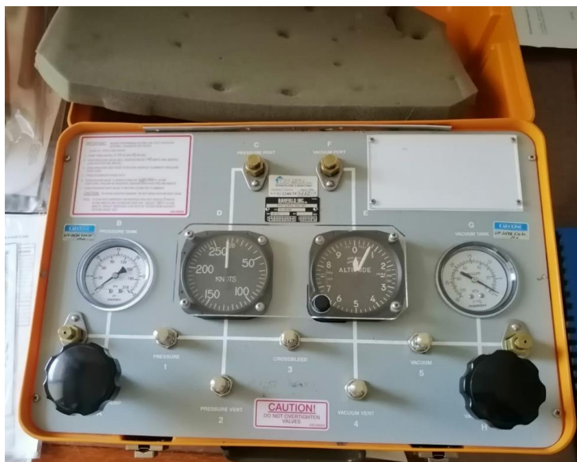
Slika 12. Ispitivački uređaj Barfield 1811 D
