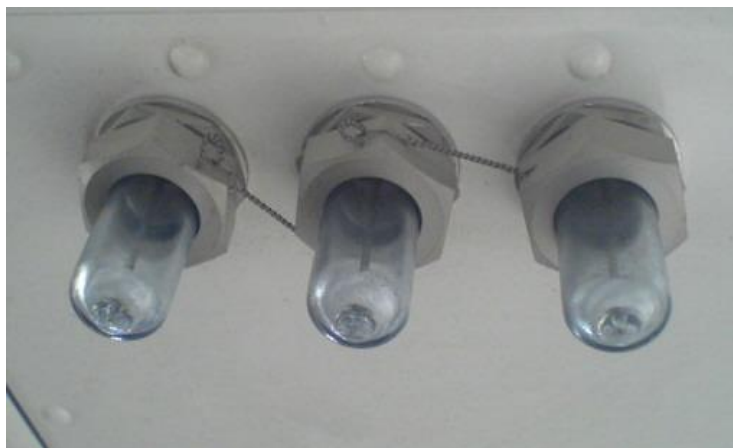
Slika 2. Ocjednici vlage pitot sustava
