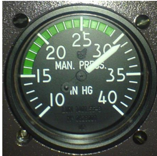
Slika 10. Prikaznik tlaka punjenja na zrakoplovu Zlin 242L
