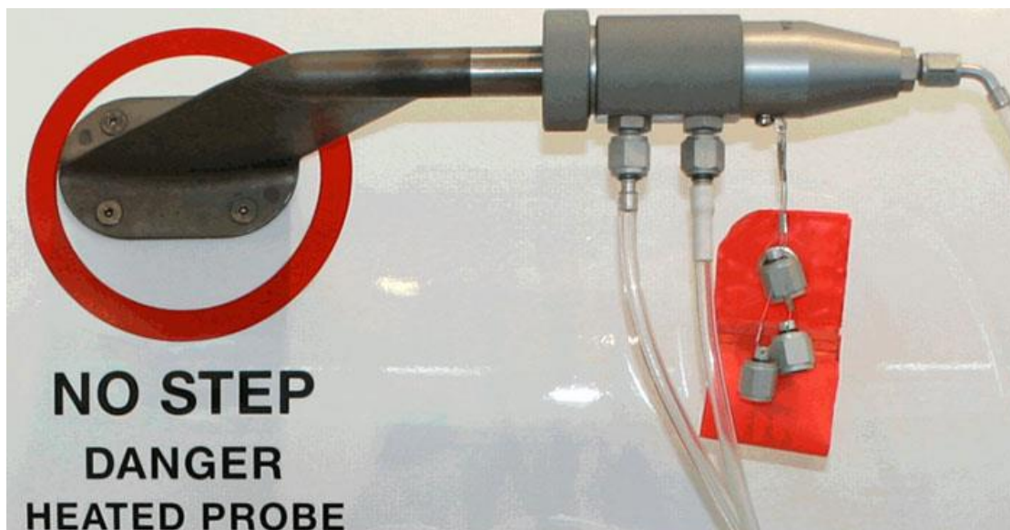
Slika 11. Adapter za pitot-prandtlovu cijev [7]
