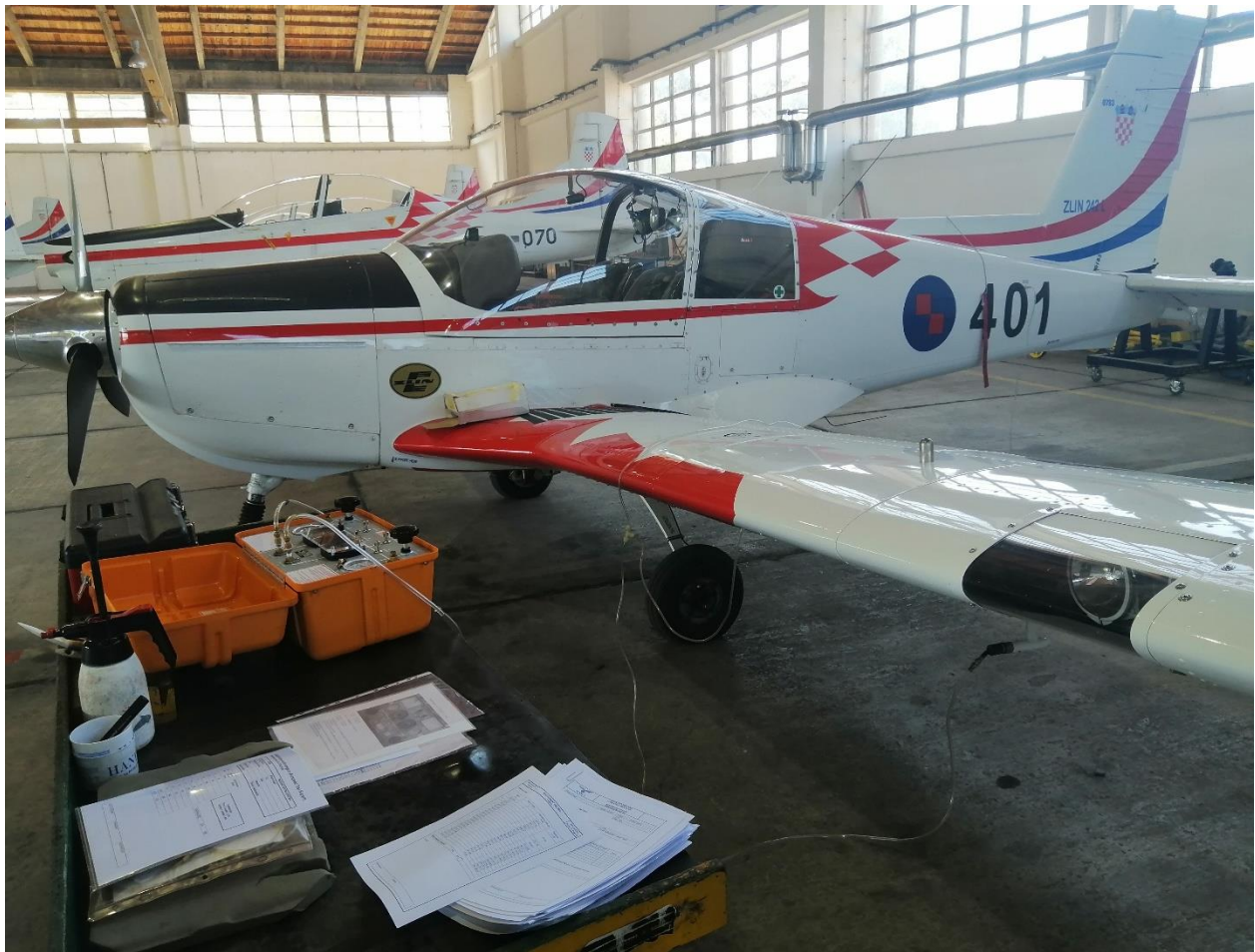
Slika 13. Provjera točnosti tlakomjernih instrumenata na zrakoplovu Zlin 242L
