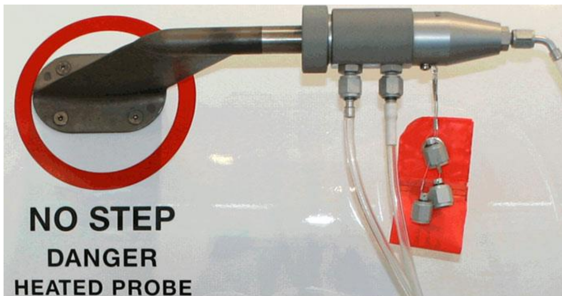
Slika 11. Adapter za pitot-prandtlovu cijev [7]
