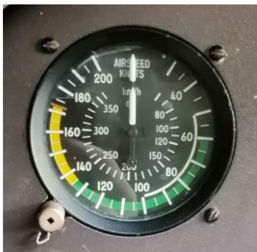
Slika 7. Brzinomjer iz zrakoplova Zlin 242L
