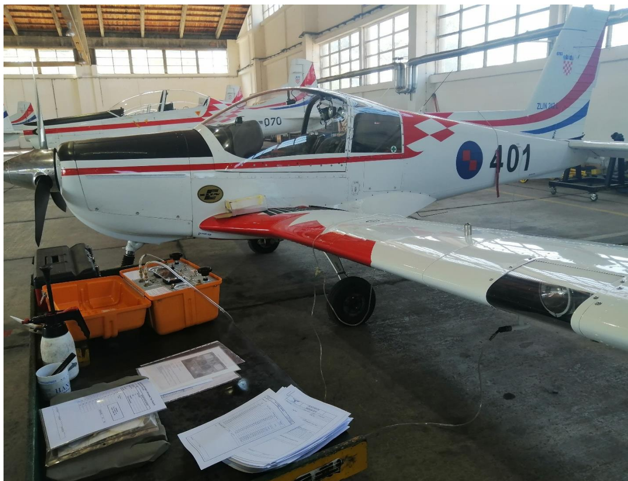
Slika 13. Provjera točnosti tlakomjernih instrumenata na zrakoplovu Zlin 242L
