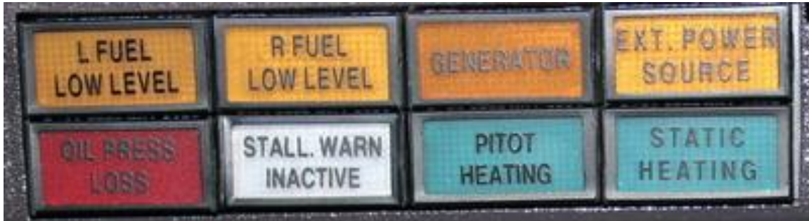
Slika 19. Ploča sa upozorenjima
