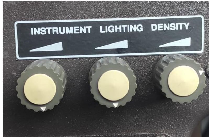
Slika 17. Potenciometri za podešavanje osvjetljenja instrumenata
