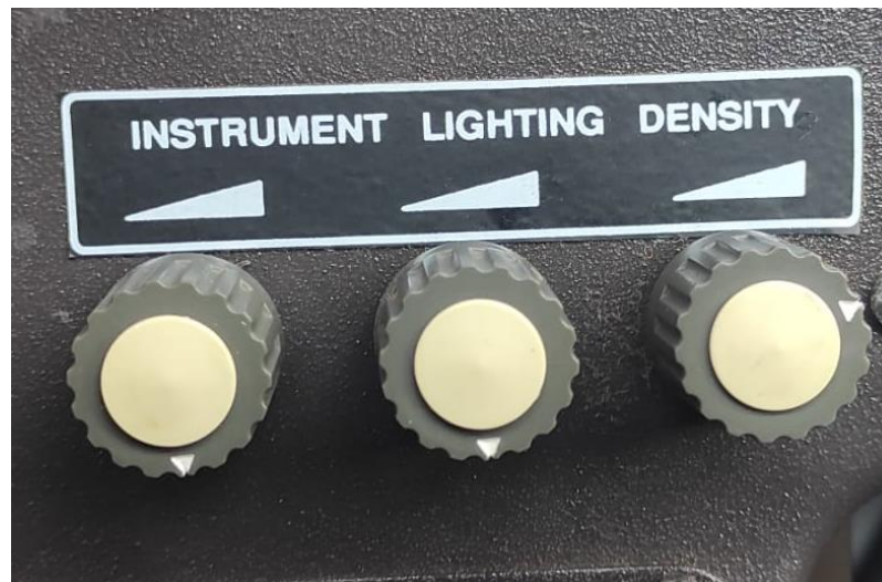
Slika 17. Potenciometri za podešavanje osvjetljenja instrumenata
