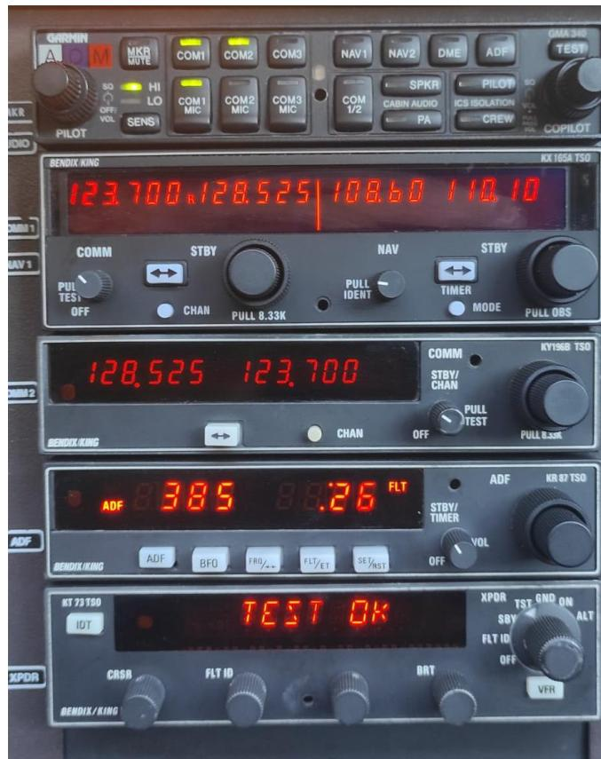
Slika 10. Komunikacijsko-navigacijska oprema
