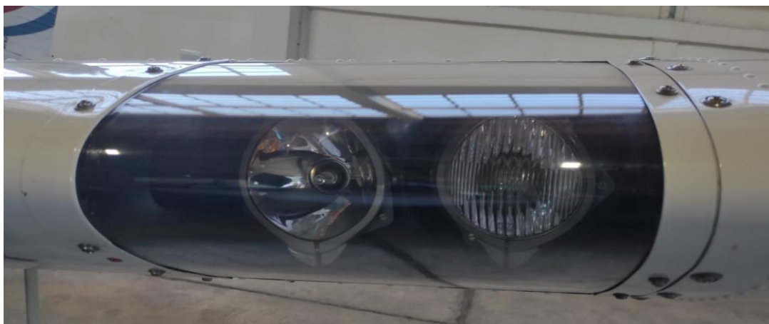
Slika 16. Svjetlo za slijetanje (lijevo) i svjetlo za voženje (desno)
