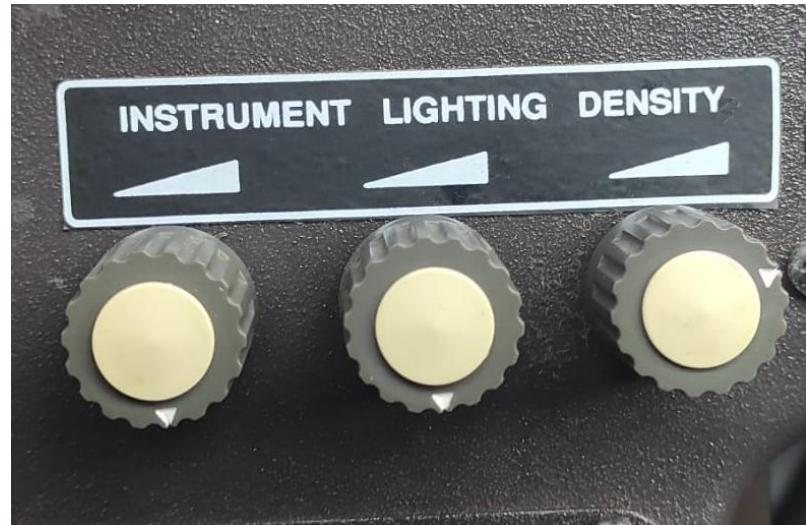
Slika 17. Potenciometri za podešavanje osvjetljenja instrumenata
