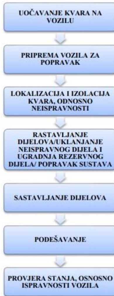
Slika 4 : Koraci prilikom obavljanja korektivnog održavanja vozila
