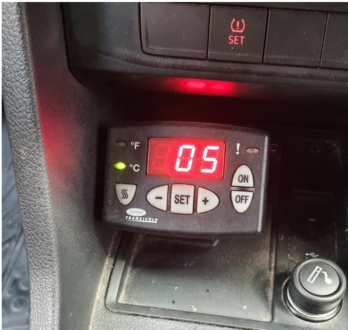
Slika 6 Računalo za praćenje temperature u hladnjači
