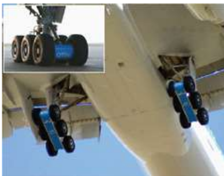
Slika 10. Dio konstrukcije zrakoplova za slijetanje koji služi za smanjenje buke od stajnog trapa testirani u QTD2.[20]
