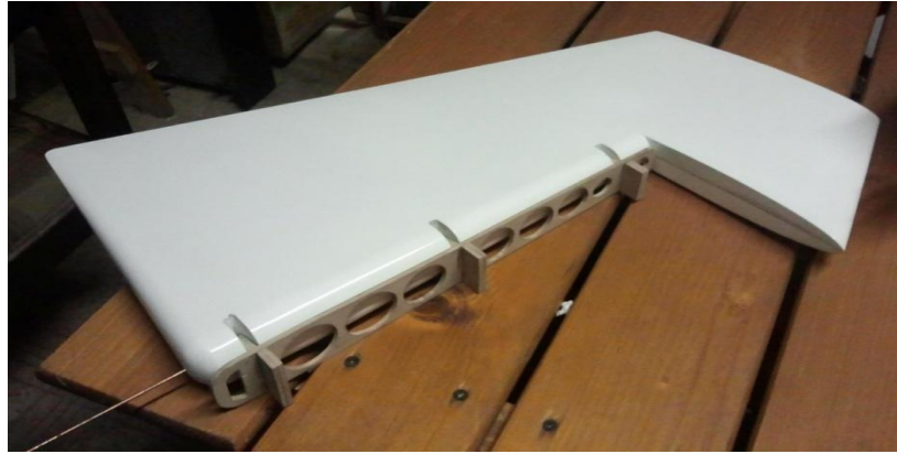
Slika 29. Prikaz prihvata upravljačke površine vertikalnog stabilizatora
