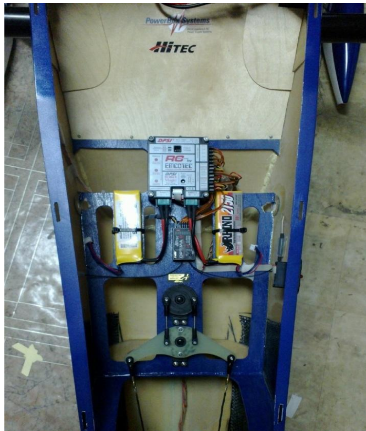
Slika 41. Prikaz ugradnje elemenata sustava upravljanja
