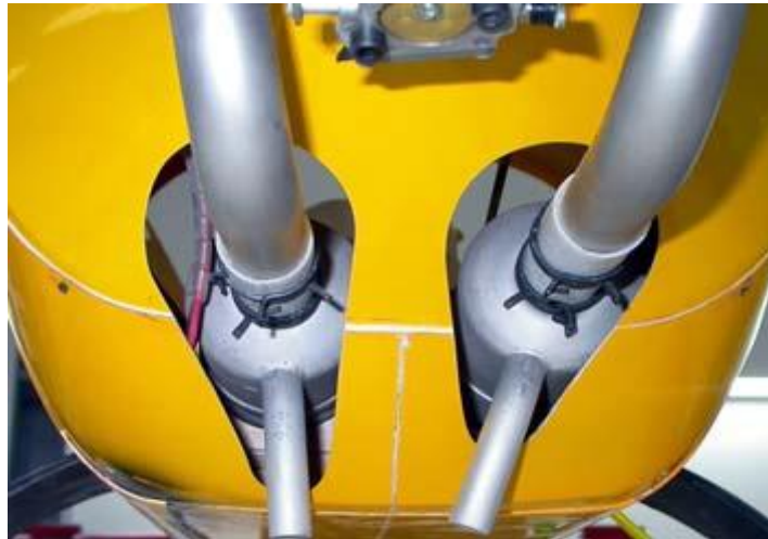
Slika 33. Prikaz ugradnje ispušnog sustava
