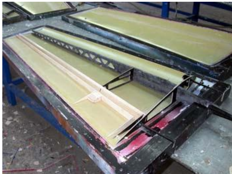
Slika 27. Prikaz procesa izgradnje krila modela zrakoplova Extra 3301
