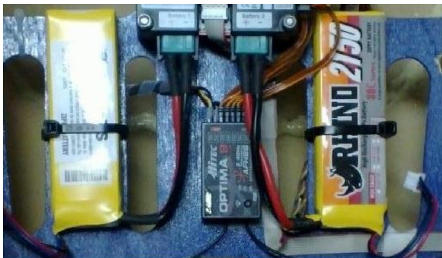
Slika 39. Prikaz ugrađene Li-Po baterije Rhino 2150
