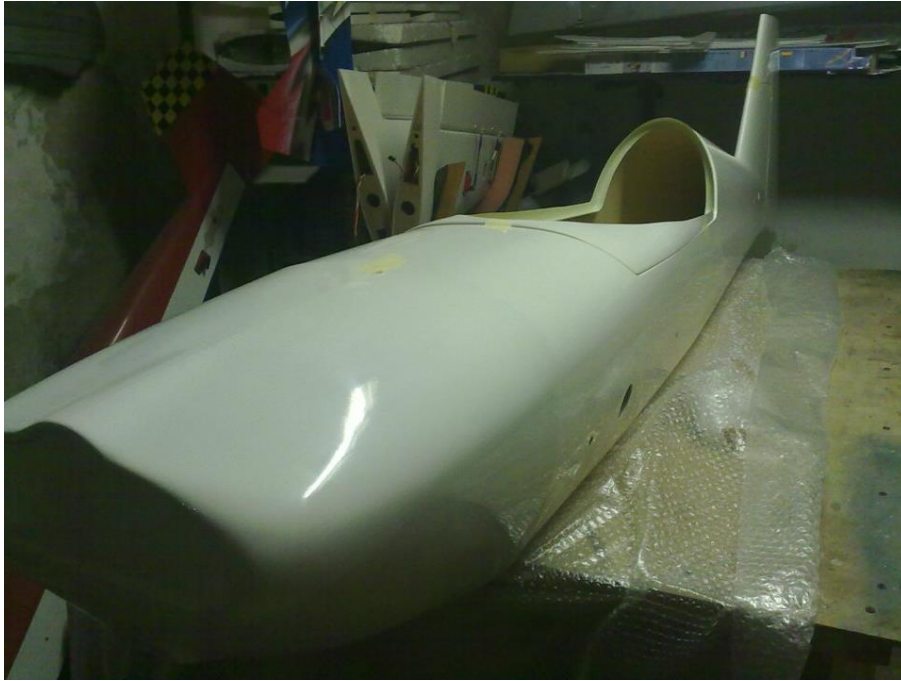
Slika 25. Izrađen trup modela zrakoplova Extra 3301
