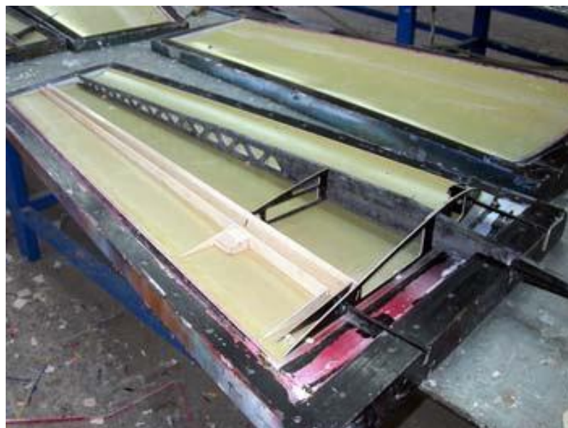
Slika 27. Prikaz procesa izgradnje krila modela zrakoplova Extra 3301
