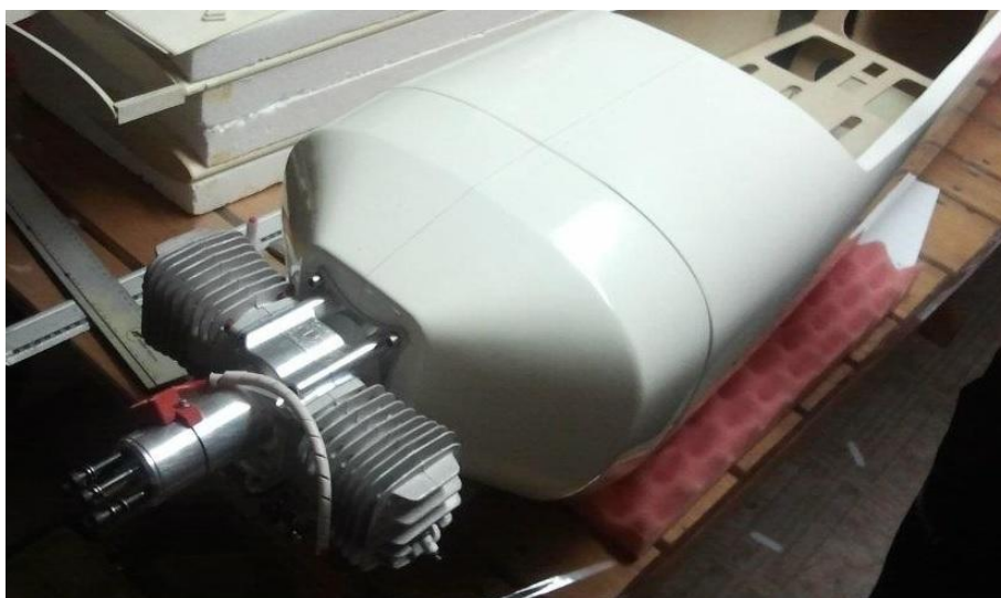
Slika 32. Prikaz ugradnje pogonskog sustava
