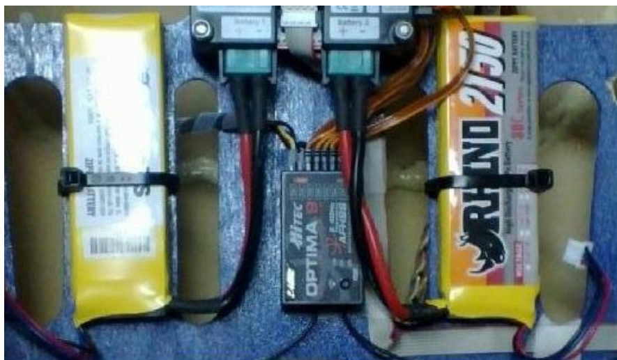
Slika 39. Prikaz ugrađene Li-Po baterije Rhino 2150
