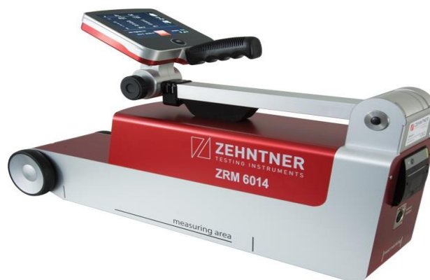
Slika 13. Uređaj za mjerenje dnevne i noćne vidljivosti
