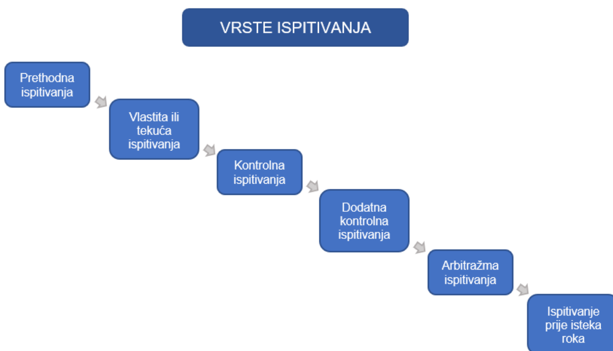
Slika 12. Vrste ispitivanja oznaka na kolniku
