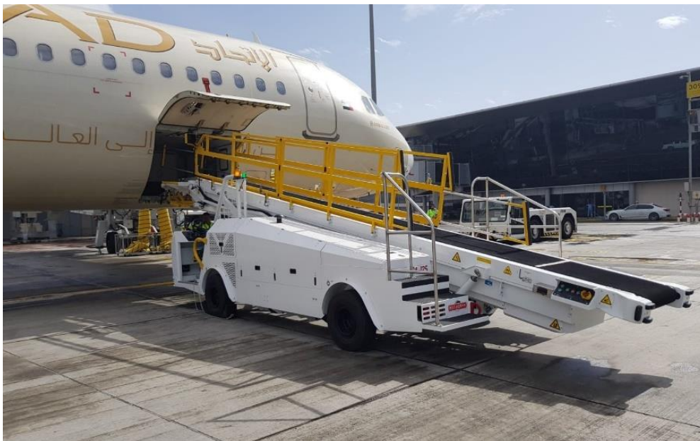
Slika 18. Mobilna tekuća traka, [28]
