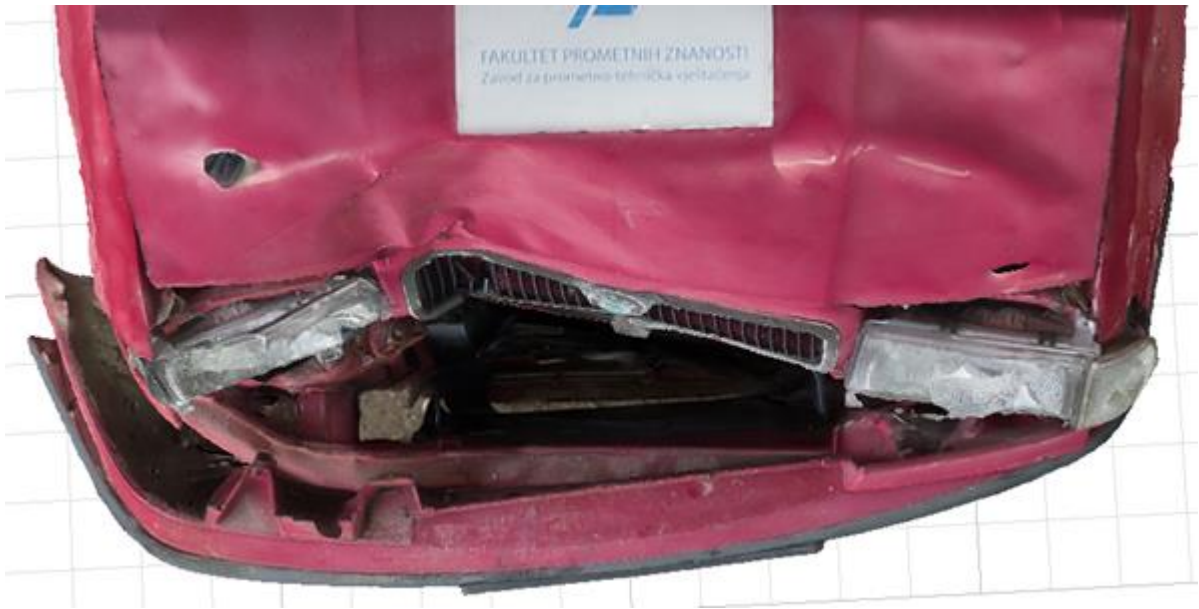
Slika 6-10 Prikaz mogućnosti fotogrametrije za određivanje oštećenja
