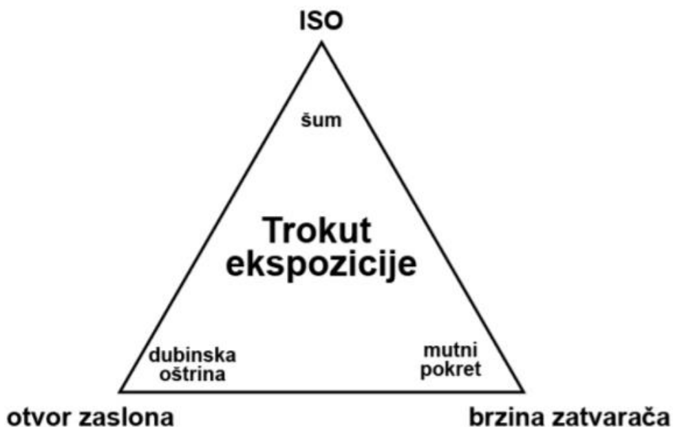
Slika 3-1 Međuviznost otvora zaslona - brzine zatvarača - ISO osjetljivost, [22]
