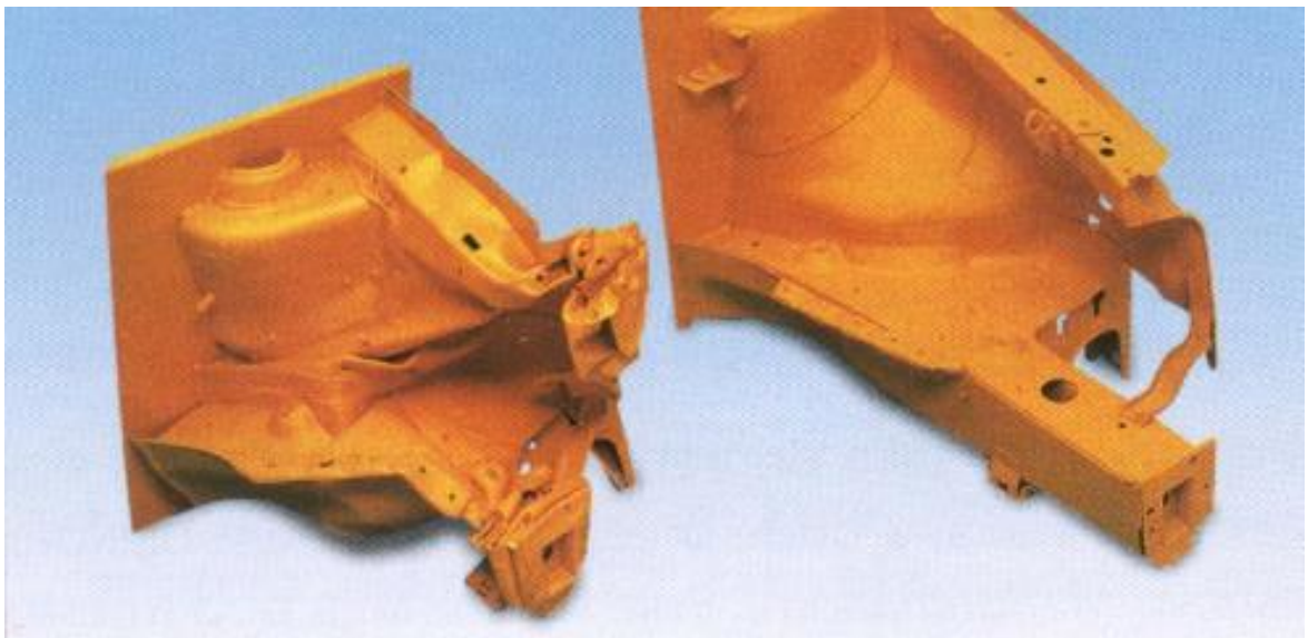
Slika 2-21 Deformacijsko ponašanje prednjeg uzdužnog nosača, [2]
