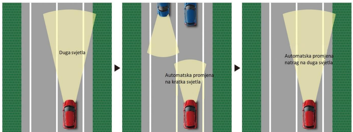
Slika 7. Princip rada automatskog paljenja dugih svjetala [13]
