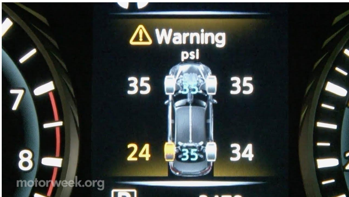
Slika 14. Prikaz upozorenja na instrument ploči za nizak tlak u gumama
