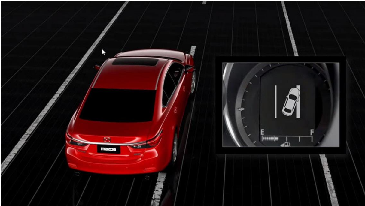
Slika 15. Funkcioniranje Lane Assist sustava na automobilu Mazda 6
