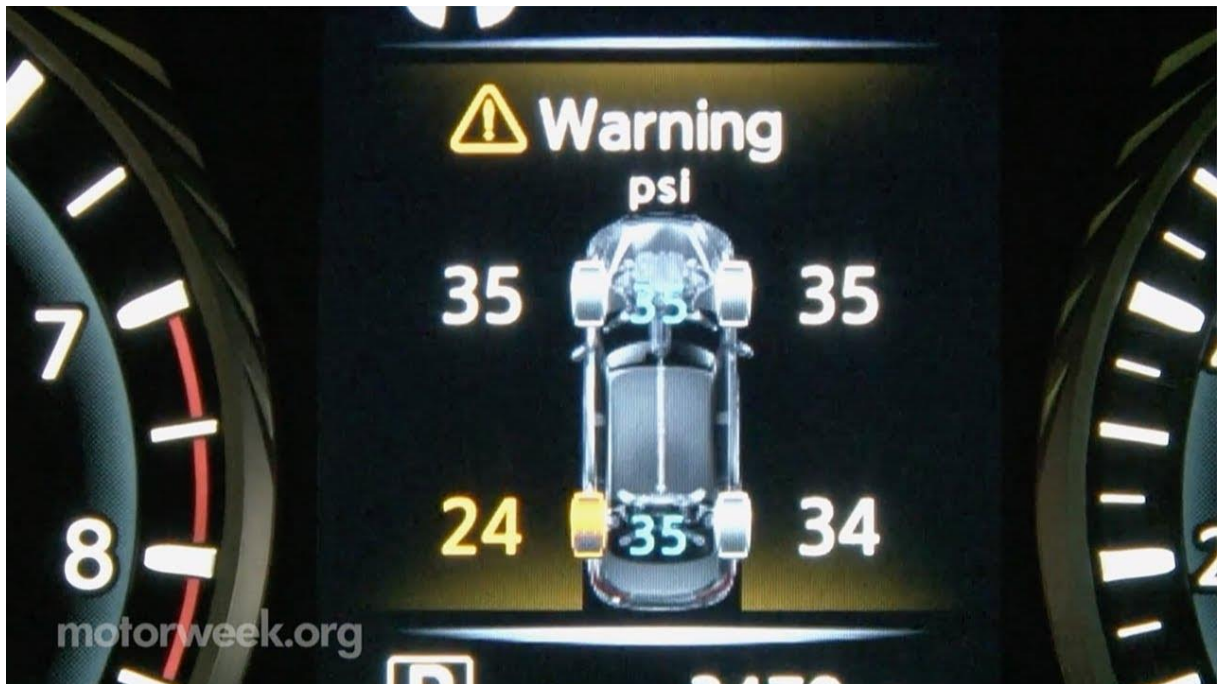
Slika 14. Prikaz upozorenja na instrument ploči za nizak tlak u gumama
