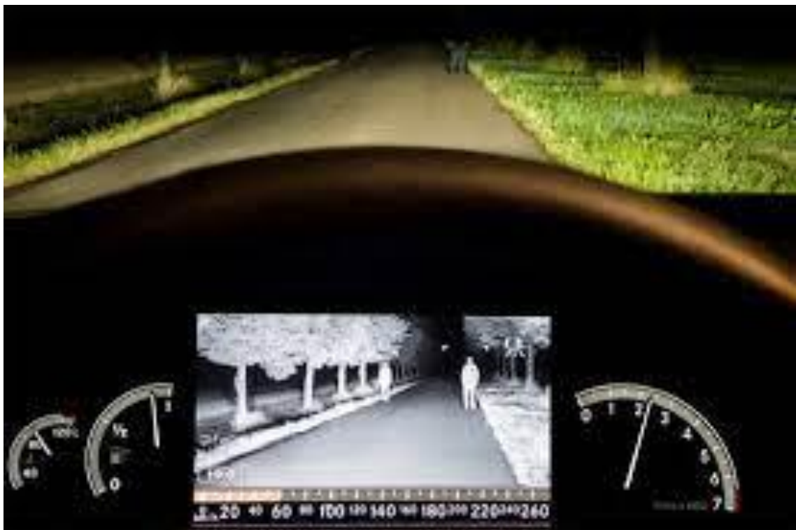
Slika 17. Korištenje noćnog vida za detekciju slabo osvijetljenih pješaka
