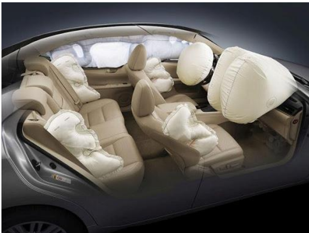
Slika 21. Zračni jastuci u prednjoj ploči, sjedalima i zračne zavjese
