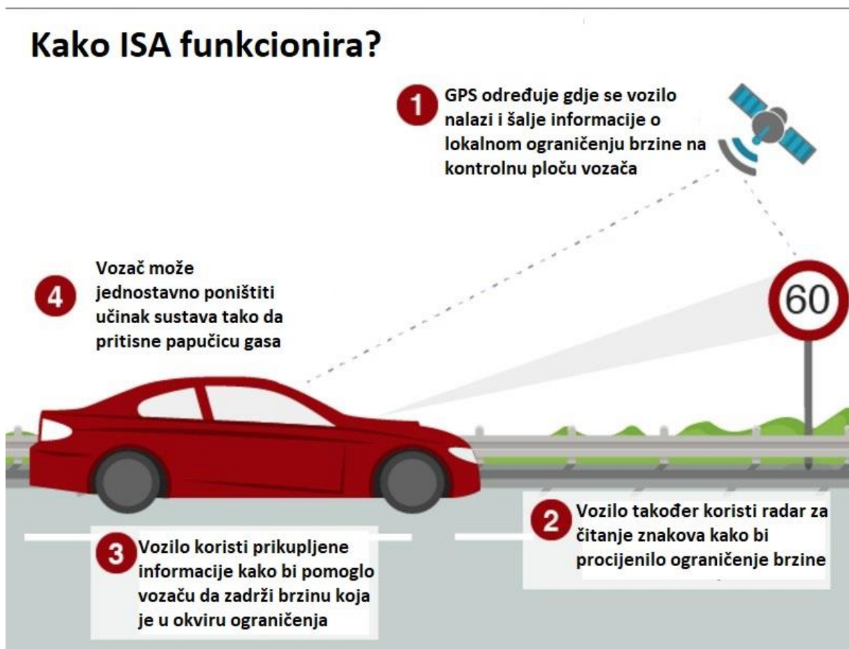
Slika 6. Način rada ISA sustava [11]
