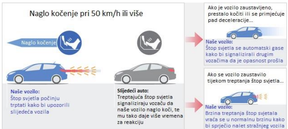
Slika 12. Način rada signala za zaustavljanje u nuždi [21]
