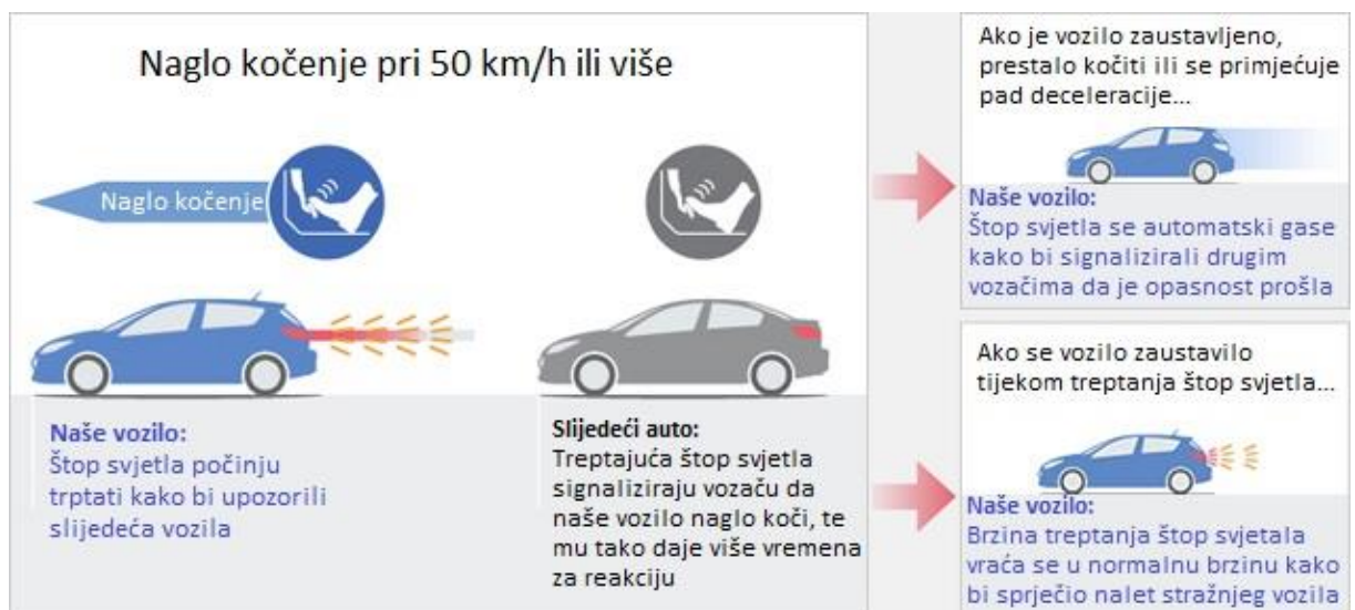
Slika 12. Način rada signala za zaustavljanje u nuždi [21]
