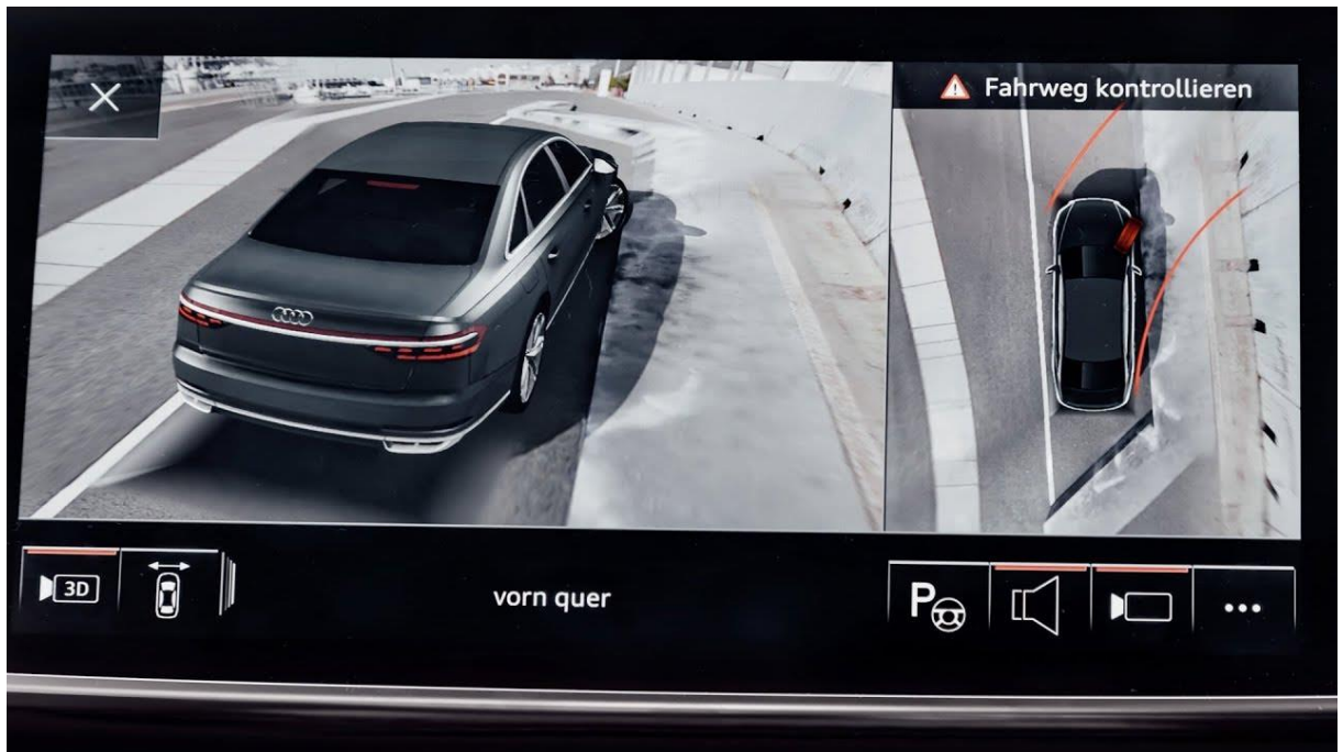
Slika 13. Prikaz 360 kamere na zaslonu automobila Audi A8 [23]
