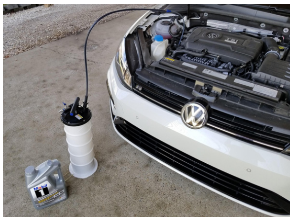
Slika 21 Postupak ispušavanja ulja [26]
