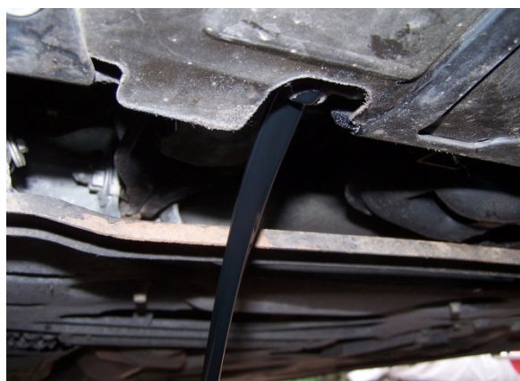
Slika 22 Postupak izlivanja ulja iz vozila [27]
