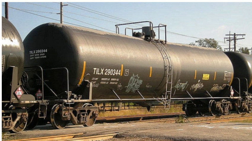
Slika 19 Spremnik za prijevoz maziva [23]
