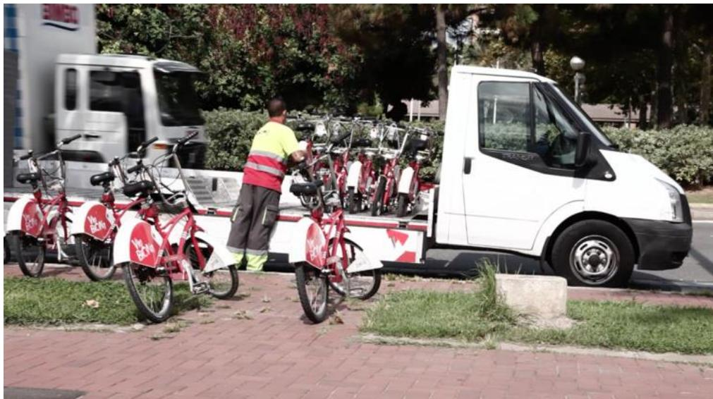
Slika 9: Vozilo namijenjeno za razmještaj bicikala
