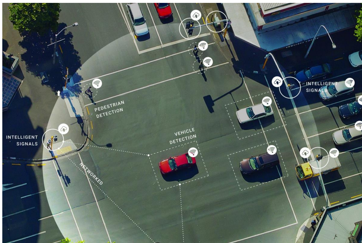
Slika 9. Detekcija situacije u prometu pomoću pametne kamere
