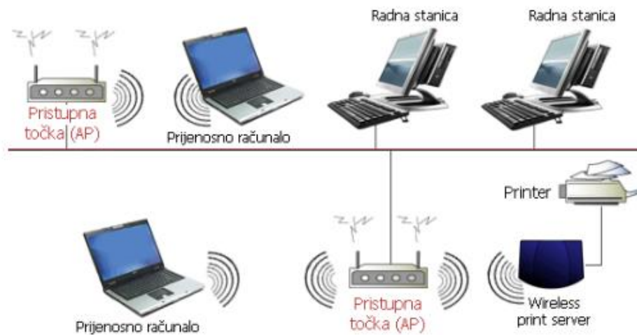
Slika 13. Infrastrukturna topologija WLAN-a-Preuzeto od [20]
