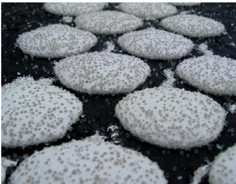
Slika 8. Staklene kuglice umetnute u materijal
