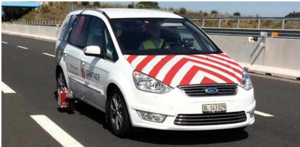
Slika 22. Mjerno vozilo s montiranim uređajem ZDR 6020
