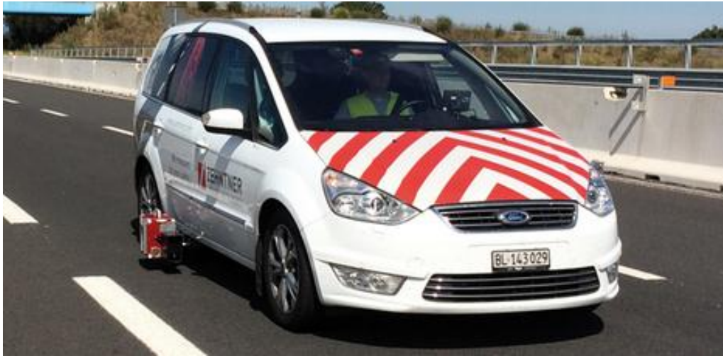
Slika 22. Mjerno vozilo s montiranim uređajem ZDR 6020
