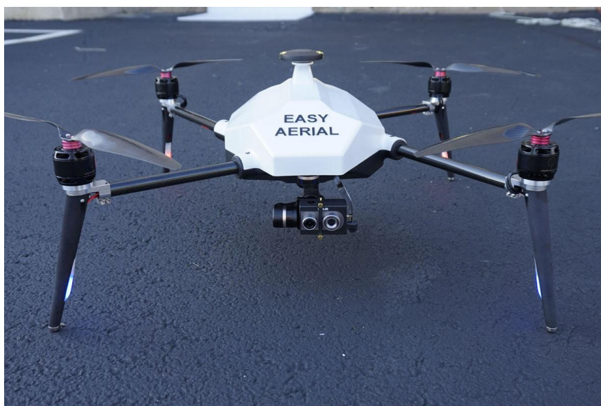
Slika 17. Prikaz Easy Aerial SAMS Falcon bespilotne letjelice za nadzor
