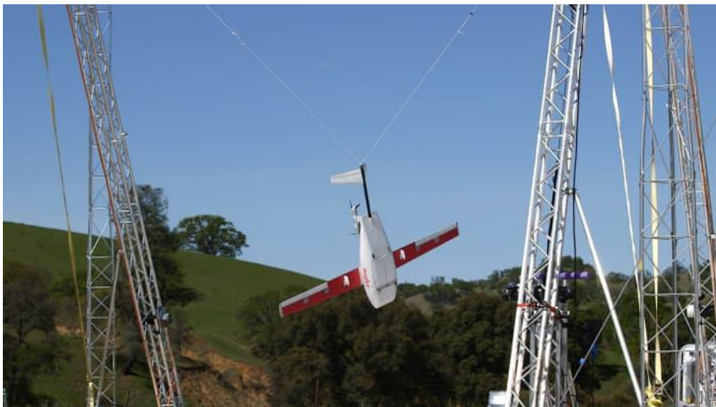
Slika 6. Slijetanje drona prikačivanjem za kabel
