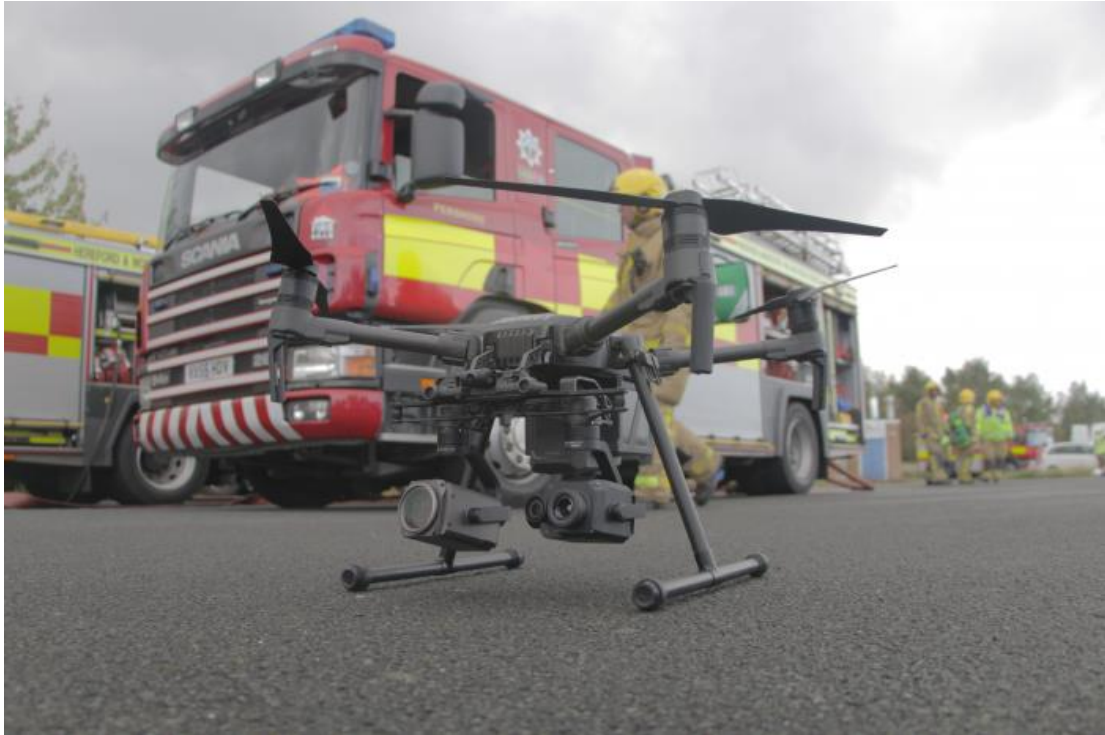
Slika 19. DJI M210 bespilotna letjelica u vatrogasnoj službi
