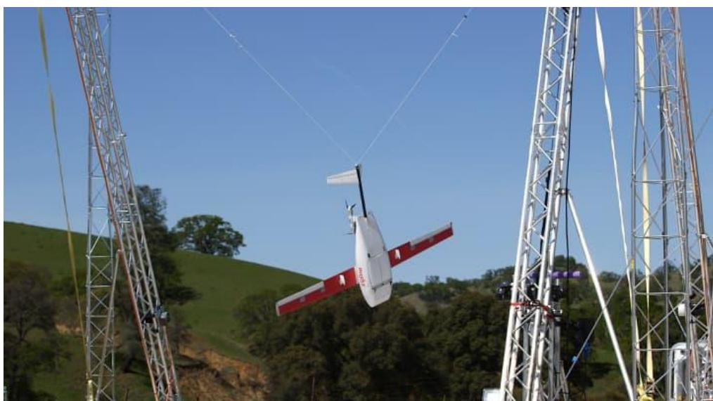
*Slika 6. Slijetanje drona prikačivanjem za kabel*
