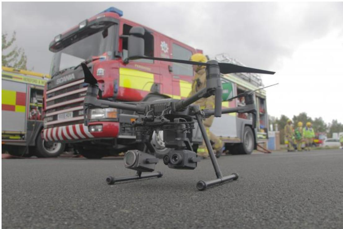
Slika 19. DJI M210 bespilotna letjelica u vatrogasnoj službi
