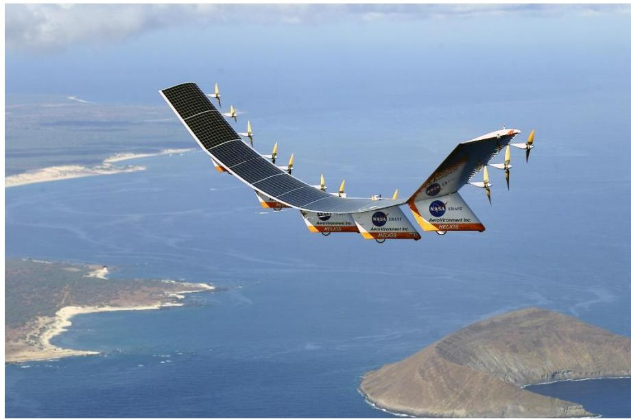
Slika 3. Prikaz prve bespilotne letjelice na solarni pogon HALSOL
