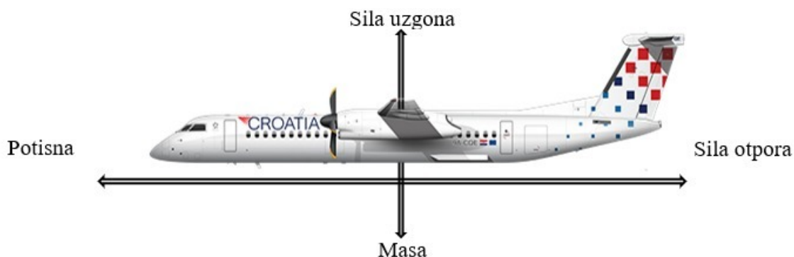
Slika 1. Prikaz aerodinamičkih sila u horizontalnom letu Izvor: [3]
