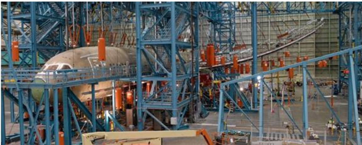
Slika 10. Ispitivanje statičke čvrstoće konstrukcije zrakoplova
