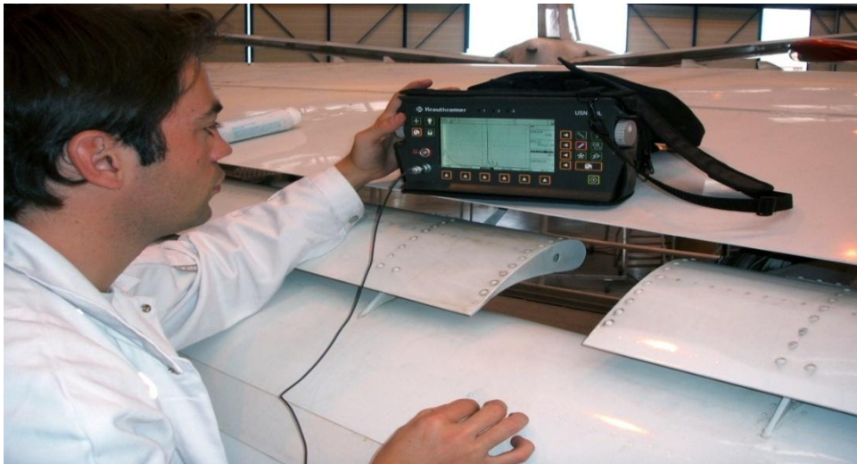
Slika 9. Ne-destruktivna inspekcija strukture zrakoplova
