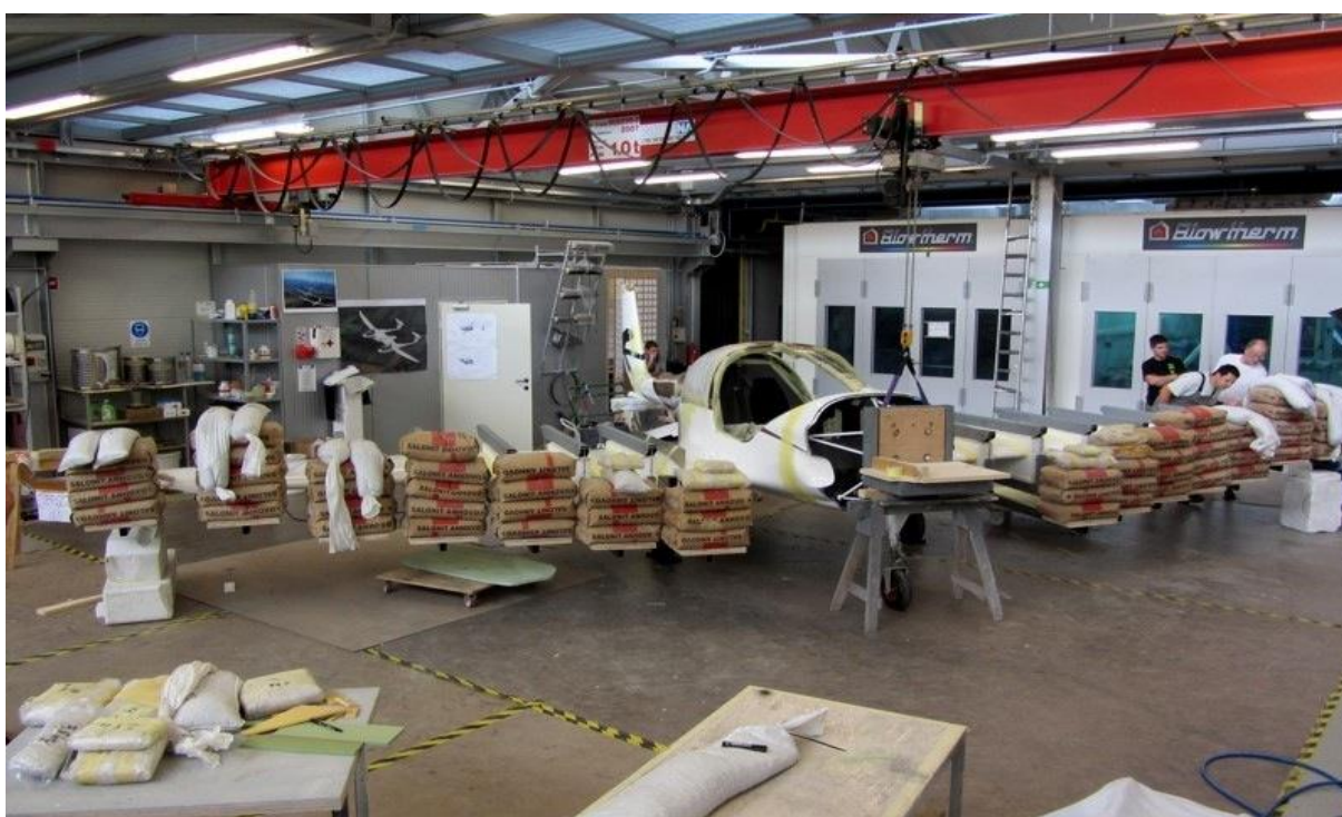
Slika 14. Ispitivanje statičke čvrstoće konstrukcije
