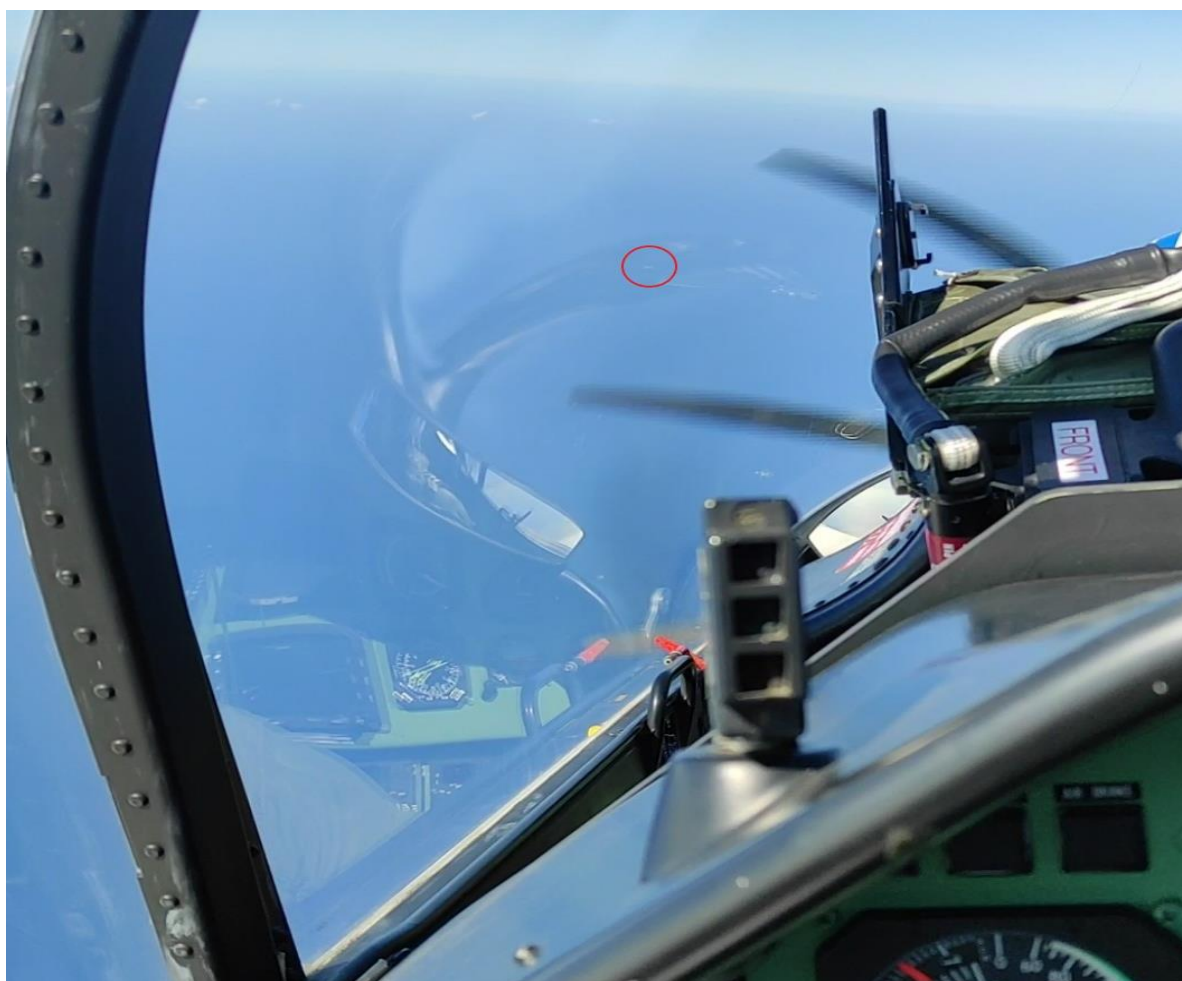
Slika 39. 2D prikaz udaljenosti prilikom uočavanja mete
